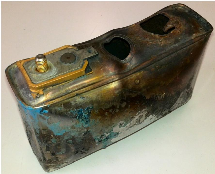
**Abbildung 6: zerstörte Li-Ionen-Zelle nach massiver Überladung**
