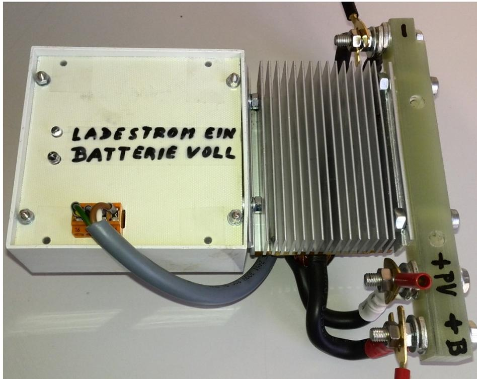
Abbildung 33: Prototyp des Laderegler - Vorderseite
