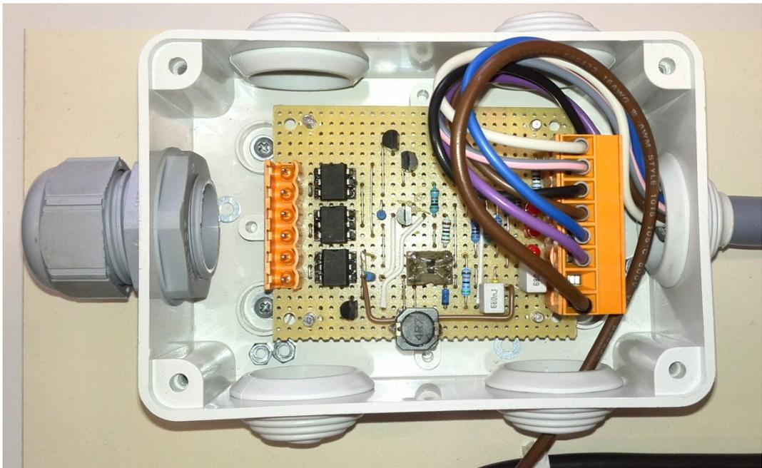
**Abbildung 41: Platine des Balancer-Leistungsteils**
