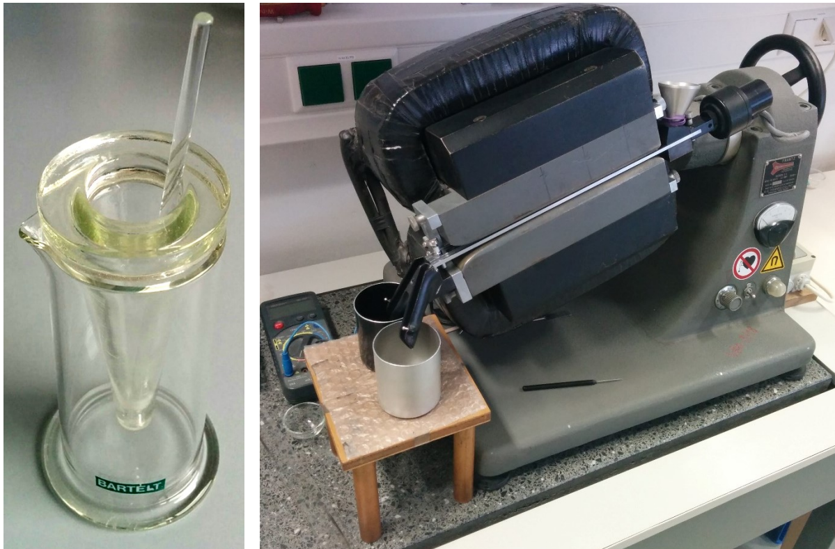
Abbildung 20: links: Scheidetrichter; rechts: Frantz-Isodynamic Scheider
