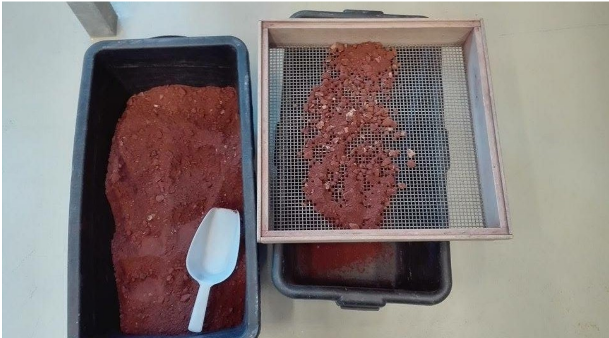
Abbildung 2: Eingangsprobe des äthiopischen Golderzes
