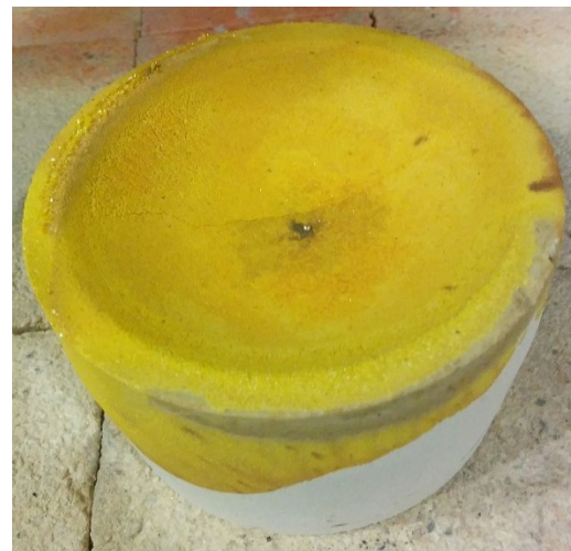
Abbildung 47: Versuche in Brixlegg links-oben: Scherbeneinwaage; rechts-oben: Muffelofen mit eingesetzten Scherben; links-unten: Bleikönig mit Schlacke; rechts-unten: Geblicktes Edelmetallkorn auf 500g Kupelle
