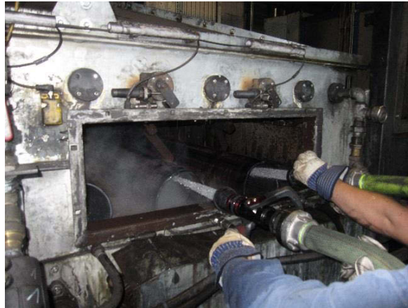
Abbildung 3-15: Innenkühlen der Flaschen an den Positionen 2 und 3 mit kaltem Wasser
