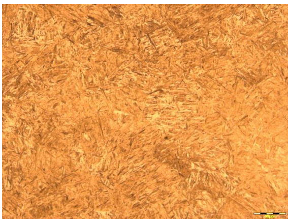
Abbildung 4-27: V1/120 Pos. 1; IH – Martensit mit Bainit
