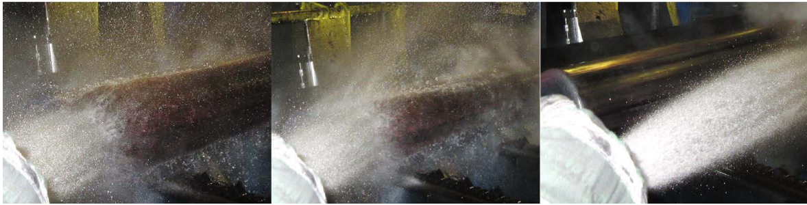
Abbildung 3-14: Vorgang der ungleichmäßigen Abkühlung mit kaltem Wasser unter Verwendung einer Löschpistole
