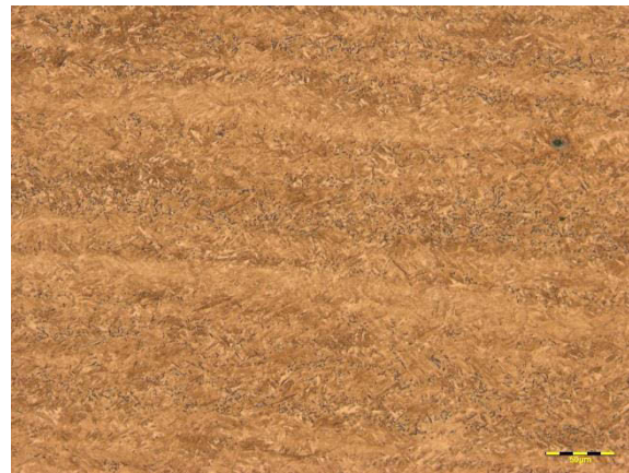
Abbildung 5-11: V2/120 Pos. 4; KH – Gefüge aus unterem Bainit und Martensit
