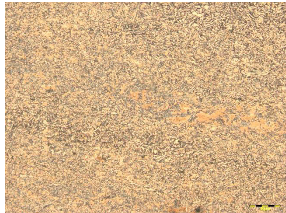
Abbildung 4-59: V6 Pos. 4; AH – Gefüge aus feinem Bainit mit vereinzelt kleinen Martensitinseln
