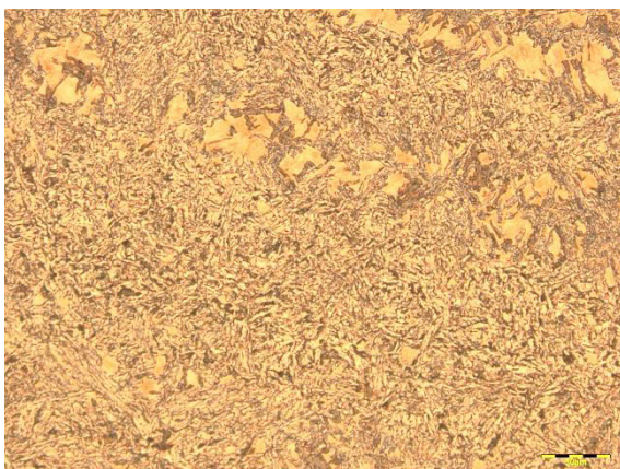
Abbildung 4-19: V0 Pos. 3; KH – Gefüge aus oberem Bainit mit Martensitzellen
