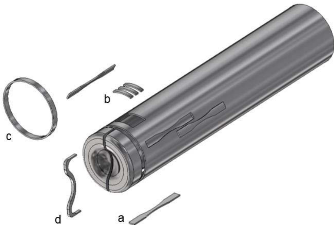
Abbildung 3-18: Entnahmestellen für die jeweiligen Proben an der Flasche
