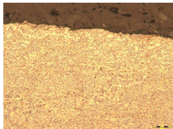
Abbildung 4-43: V00 Pos. 4; AR – Gefüge aus oberem Bainit mit Martensitinseln und Ferrit im Randbereich
