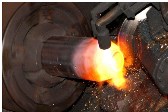
Abbildung 2-3: Einformen des Flaschenhalses mit dem Spinning-Prozess [5]
