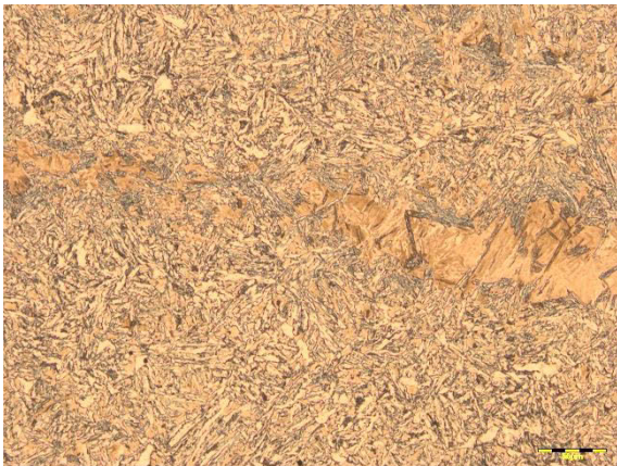
Abbildung 4-58: V6 Pos. 1; AH – Gefüge aus relativ grobem oberem Bainit mit Martensitzelle
