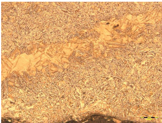
Abbildung 4-17: V0 (lange Wärmdauer) Pos. 2; IR – Gefüge aus oberem Bainit mit Martensitzellen
