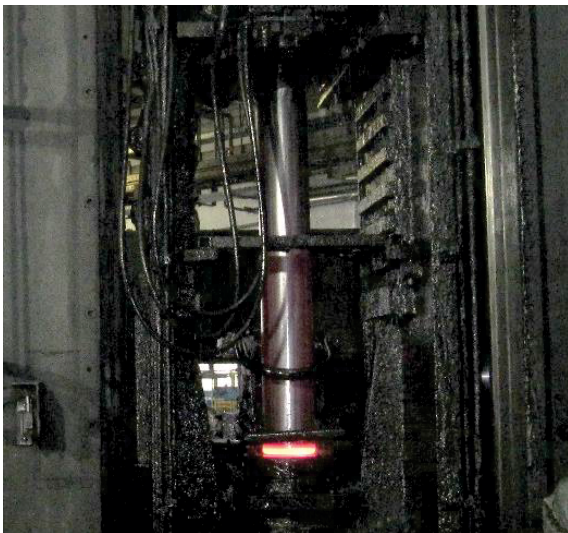
Abbildung 3-11: Flasche am Dorn nach dem Ziehvorgang. Die „kalte“ Flaschenwand und der noch rot glühende Boden sind gut erkennbar.
