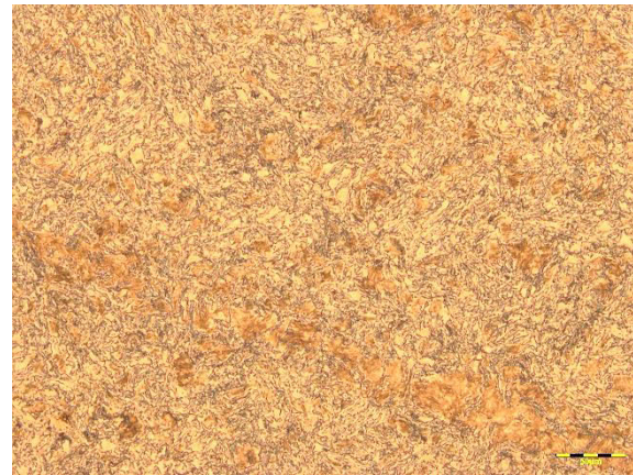
Abbildung 4-47: V00 Pos. 3; IH – Gefüge aus oberem Bainit durchzogen mit Martensitinseln
