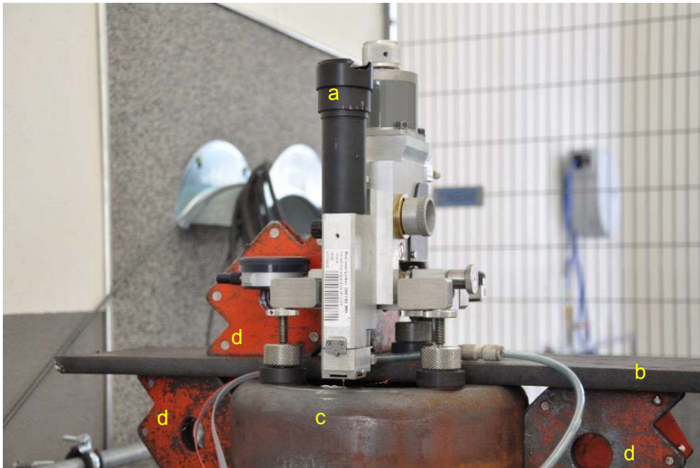
Abbildung 3-8: Anordnung des Messgeräts auf dem Flaschenboden zur Bestimmung der Eigenspannungen
