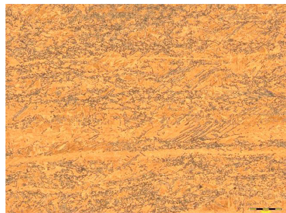
Abbildung 4-28: V1/120 Pos. 4; IH – Zeiliges Mischgefüge aus Martensit und Bainit
