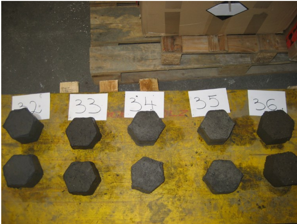
Abbildung 61: Betonsteine verschiedener Mischungen mit ähnlicher Geometrie der Großanlage, hergestellt mittels Handpresse in Brixlegg
