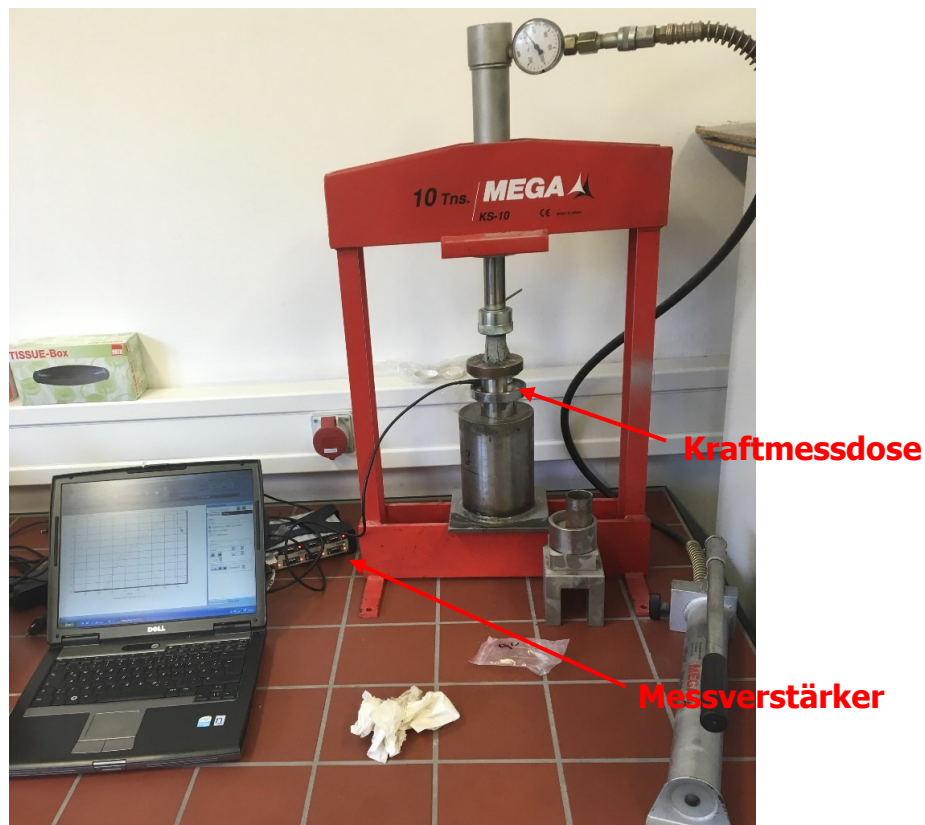
Abbildung 68: Prüfpresse Mega KS-10 mit Messverstärker und Kraftmessdose
