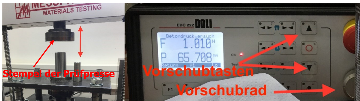
Abbildung 65: Bewegung des Stempels der Presse
