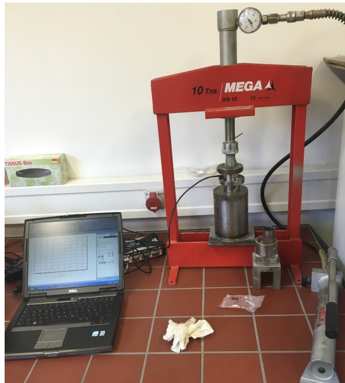
Abbildung 32: Prüfeinrichtung Mega KS-10 mit Kraftmessdose und Messverstärker
