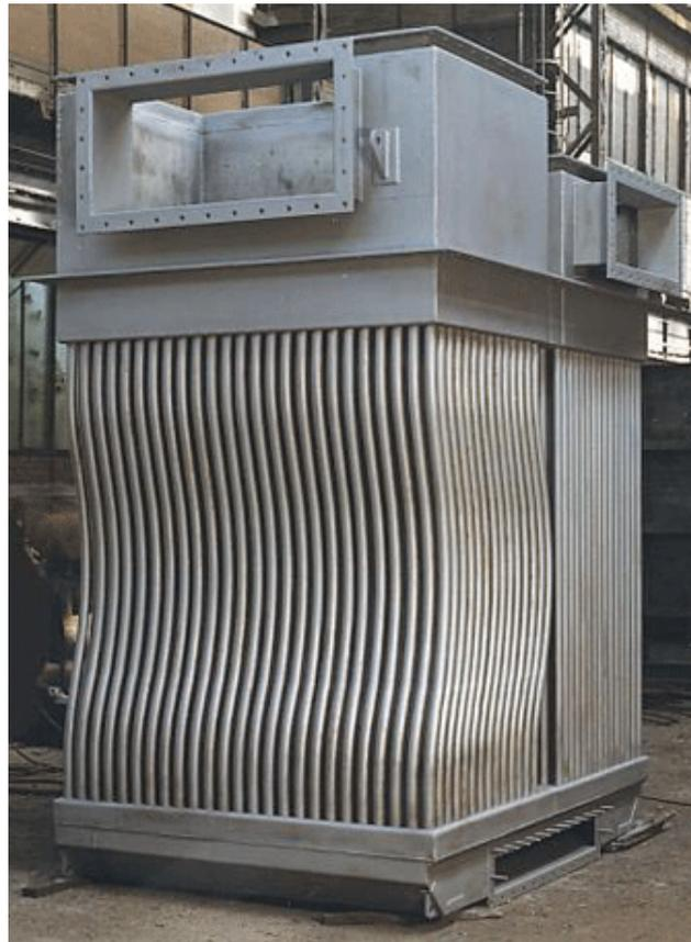
Abbildung 4.3: Register eines Rekuperators mit lyraförmig gebogenen Rohren an der Abgas-eintrittsseite [20]
