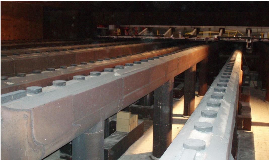
Abbildung 4.2: Balken des HBO mit Feuerfestmaterial-Ummantelung [3]
