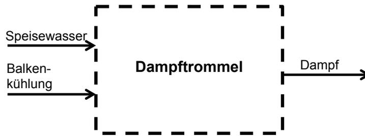
Abbildung 5.3: Bilanzraum Dampftrommel
