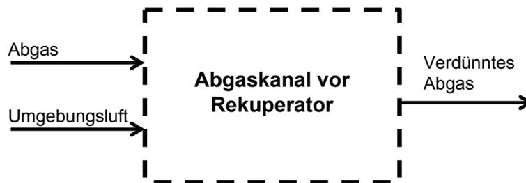
Abbildung 5.4: Bilanzraum Abgaskanal vor Rekuperator
