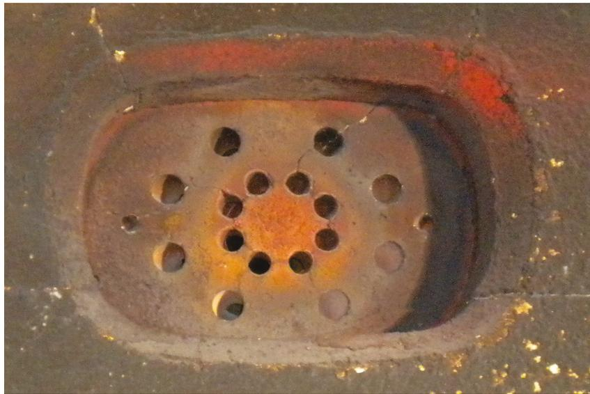
Abbildung 2.5: Breitflammenbrenner [3]
