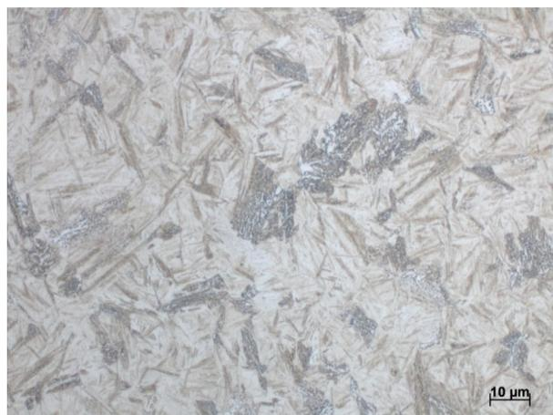
**Abbildung 29:** Schliffbild des 42CrMo4, Rand,  $\lambda = 1,20$ . Das Gefüge besteht aus Martensit (hell mit Nadeln) mit Bainitinseln (strukturierte dunkle Bereiche)
