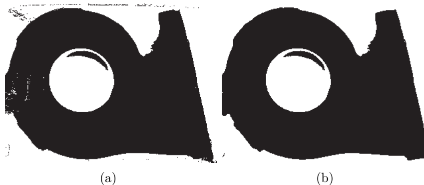
Abbildung 4.5: (a) Automatisch generierte Maske auf Basis einer minimalen Temperaturerhöhung von 300 DL während der Heizphase und einer minimalen Temperaturerhöhung von 8 DL in den 30 ms nach Ende des Heizpulses; (b) Automatisch generierte Maske auf Basis einer minimalen Temperaturerhöhung von 300 DL während der Heizphase und einer minimalen Phasenverschiebung der Temperatur- Basisschwingung von 2 rad;
