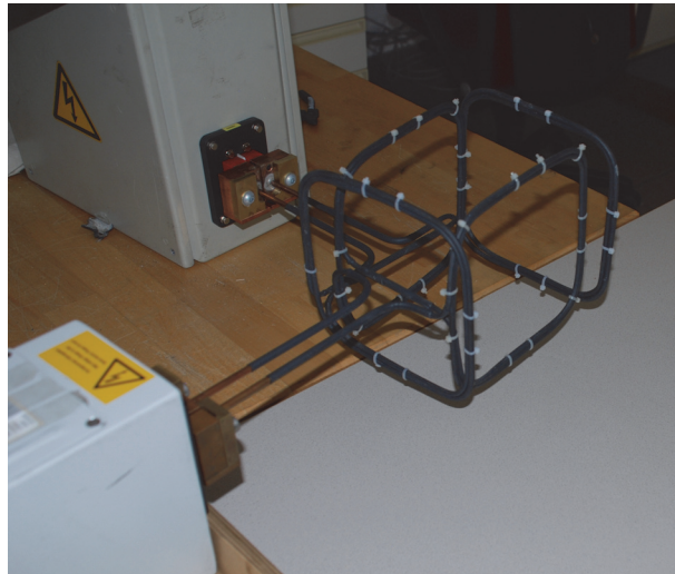
Abbildung 3.9: Messaufbau mit zwei Spulen und zwei HF-Generatoren zum Erzeugen eines schwebenden Magnetfeldes zur omnidirektionalen Erwärmung des Bauteils.
