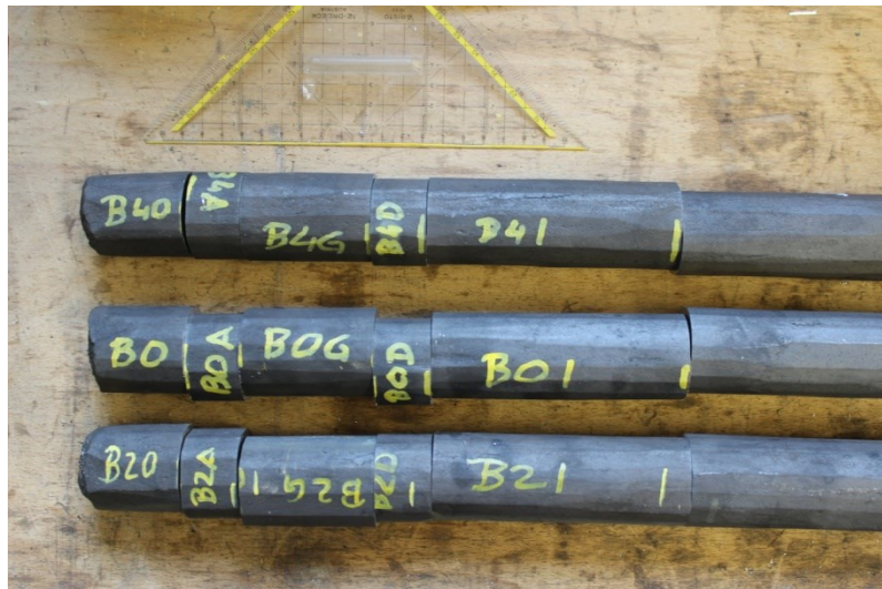
Abbildung 6-1 Entnahme Stelle für B03, Kerbschlag- und Korrosionsproben
