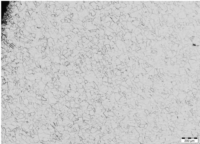
Abbildung 6-6 Schmiedegefüge von Block 20 bei 50x Vergrößerung aus dem Randbereich
