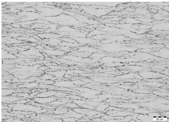
Abbildung 6-22 P556 mit 20 ppm bei 900°C umgeformt 200x Vergrößerung, Probe aus dem Zentrumsbereich der Stauchprobe
