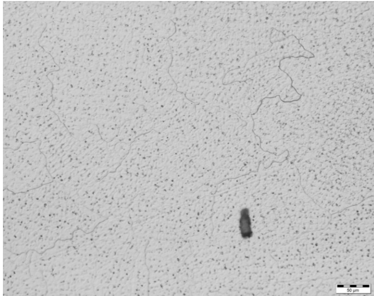
Abbildung 4-10 Schleudergussgefüge des P556 mit 20 ppm Bor, mit Oxalsäure geätzt aus dem Randbereich 200x Vergrößerung
