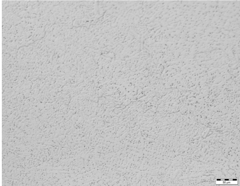
Abbildung 4-12 Schleudergussgefüge P556 mit 40 ppm Bor, mit Oxalsäure geätzt aus dem Randbereich 200x Vergrößerung
