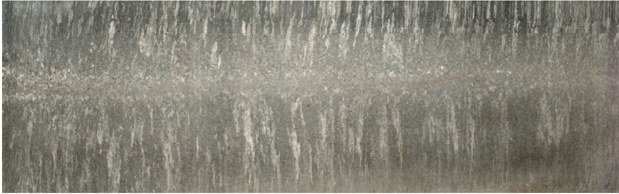
Abbildung 5-8 P556 mit 20 ppm Bor nach Guss mit Makroätzung
