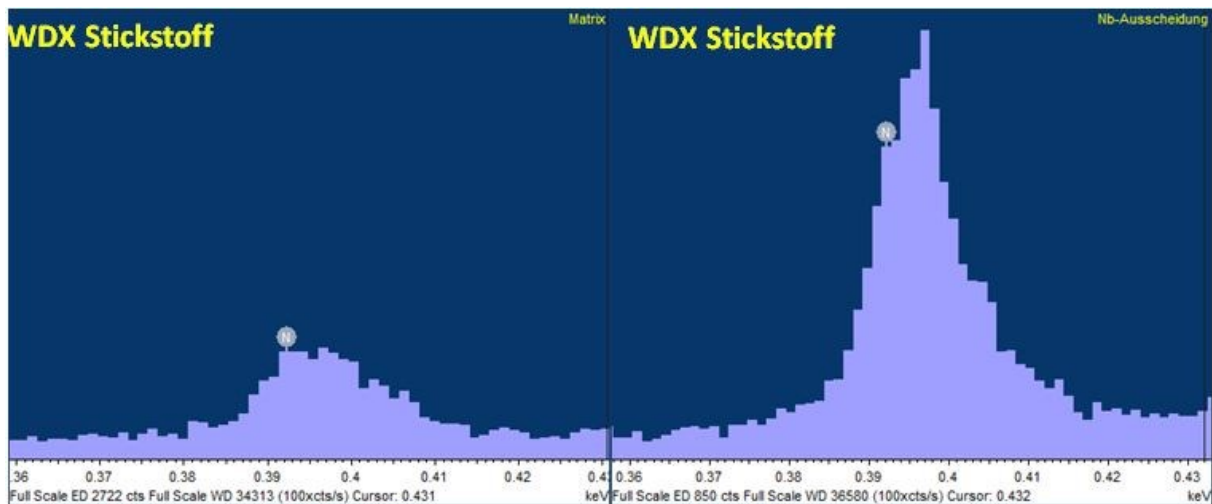
Abbildung 4-8 WDX Analyse der Probe P556 mit 0,5% Niob, links qualitative Analyse der Matrix, rechts qualitative Analyse der niobreichen Ausscheidung mit deutlichen Stickstoffpeak
