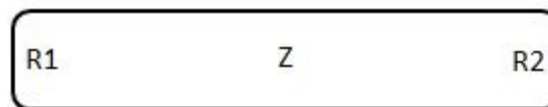
Abbildung 6-31 Schematische Darstellung einer Gleebleprobe, zur Verdeutlichung der für die Korngrößenbestimmung vorgesehen Stellen
