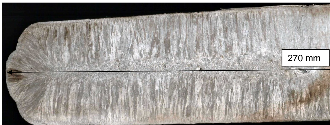
Abbildung 5-9 P556 mit 40 ppm Bor nach Guss mit Makroätzung
