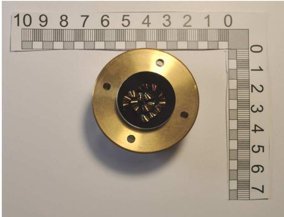
**Abbildung 5-9:** REM-Probenträger mit aufgeklebten Spänen.
