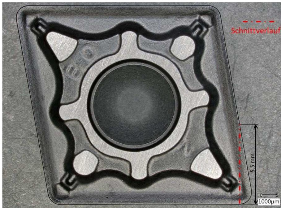
**Abbildung 5-5:** Skizze des Schnittverlaufs der Wendeschneidplatte.
