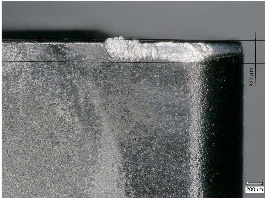
**Abbildung 5-4:** Beispiel für die Messung der Verschleißmarkenbreite.
