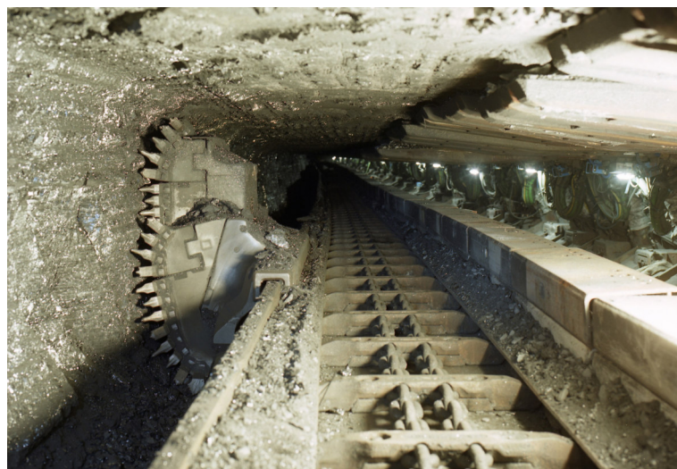
Abb. 2.10: Kratzerförderer mit Hobelanlage [19]
