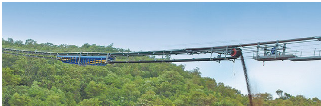
Abb. 2.13: Abwurfpunkt mit Gurtwendestrecke [21]
