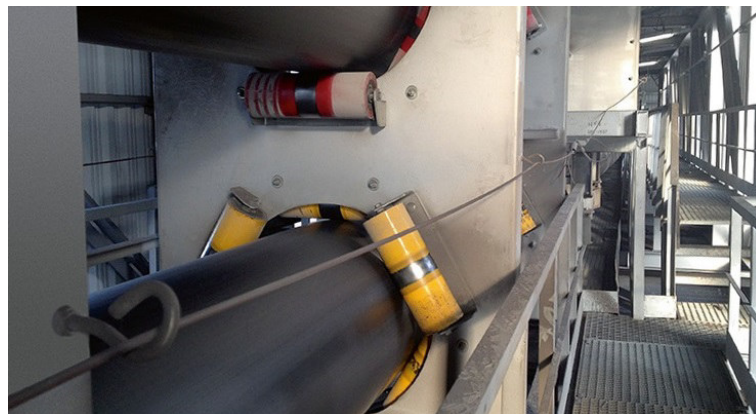
Abb. 2.8: Tragrollenstation eines Schlauchgurtförderers [17]
