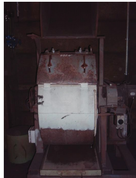
Abbildung 3-5 a und b: Trommel zur Bestimmung der Kaltfestigkeit in Vorder- und Seitenansicht
