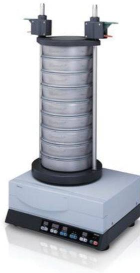
Abbildung 3-10: Siebturm am LfM
