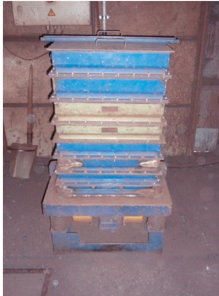
Abbildung 3-4: Siebturm inklusive der Siebeinsätze
