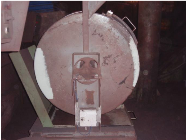
Abbildung 3-5 a und b: Trommel zur Bestimmung der Kaltfestigkeit in Vorder- und Seitenansicht
