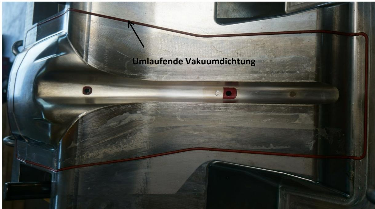
*Abbildung 69: Ausschließlich in Metall ausgeführten Kavität mit außenliegender zusätzlicher Vakuumdichtung.*
