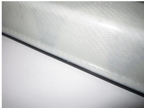
Abbildung 56: Abdichtung mittels Thermoplastvorspritzling (schwarz).
