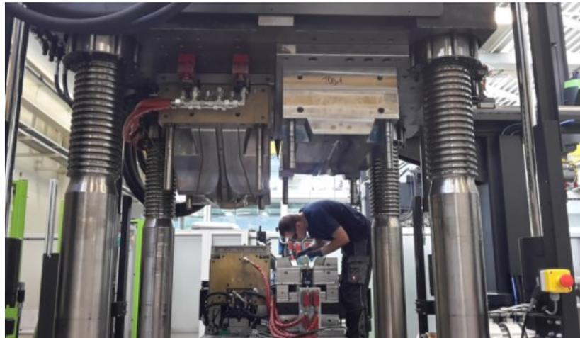
*Abbildung 98: Finale Abstimmungsarbeiten an den Trennebenen.*
