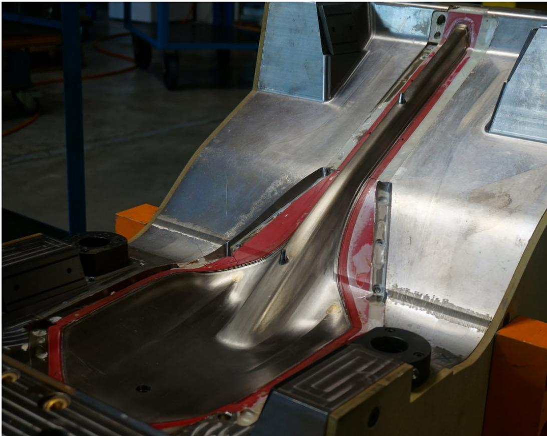
*Abbildung 68: Nutzung von Murseal<sup>®</sup> Einsätzen am gesamten Umfang der Werkzeugtrennung.*
