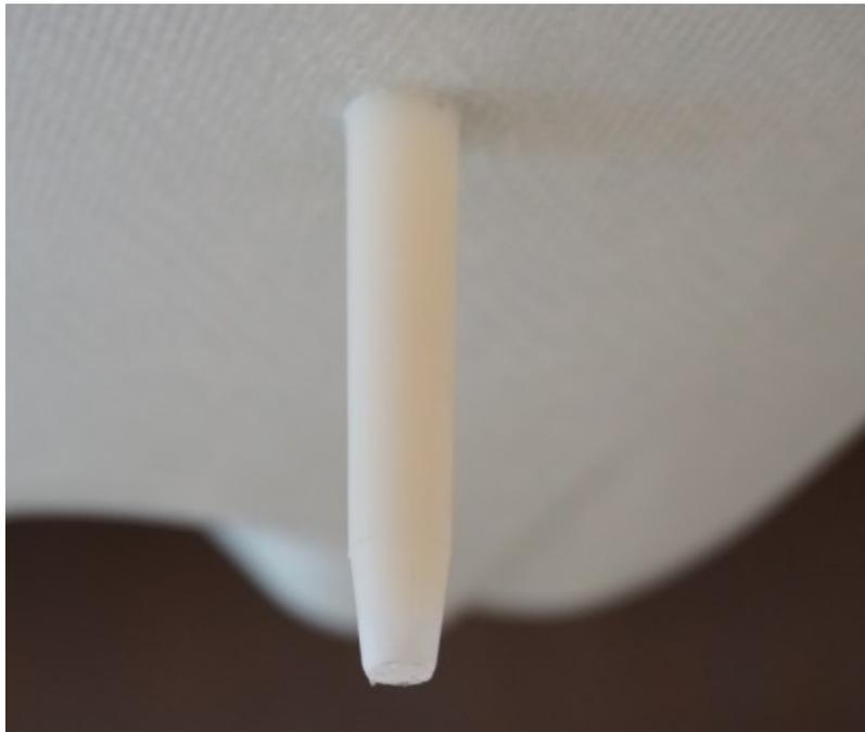
*Abbildung 52: Foto eines auspolymerisierten Angusszapfens in Werkzeuglage.*
