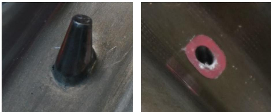
*Abbildung 99: Pin im Werkzeug zur Zentrierung des Preforms und gegenüberliegende abdichtende Buchse zur Aufnahme des Pins.*
