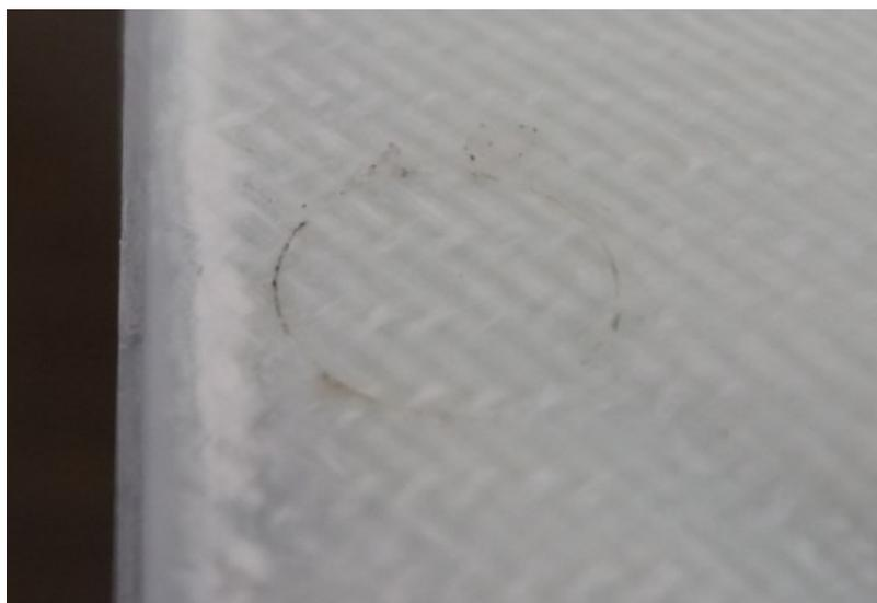
*Abbildung 76: Foto der kaum wahrnehmbaren Abzeichnung des Auswerferkopfes am fertigen Bauteil.*
