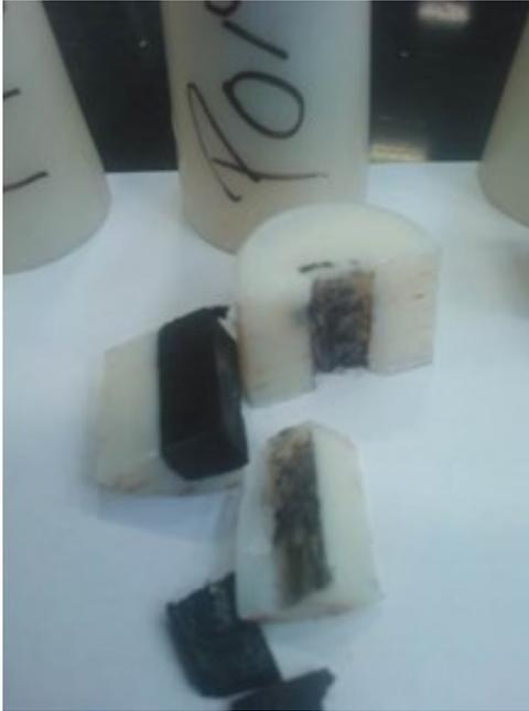
Abbildung 63: Foto des im Gusspolyamid eingebetteten POM.
