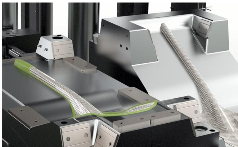
*Abbildung 97: Fotorealistische Visualisierung der beiden nebeneinander angeordneten und in der Trennebenenlage abweichenden Messewerkzeuge.*
