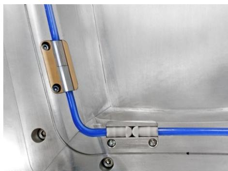
Abbildung 57: Abdichtung mittels aufblasbarer Dichtschnur der Ausführung Seal Star (blau) [33].
