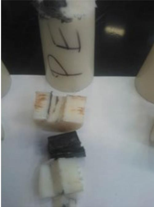
Abbildung 61: Foto des aus dem Gusspolyamid herausgelösten UHMWPE.
