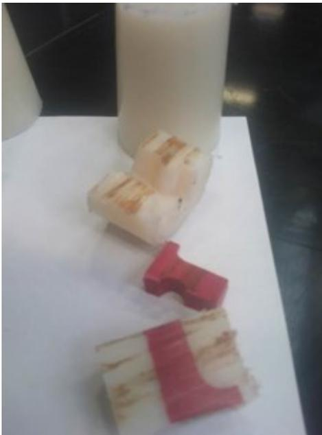
Abbildung 64: Foto des im Gusspolyamid eingebetteten Murseal®.
