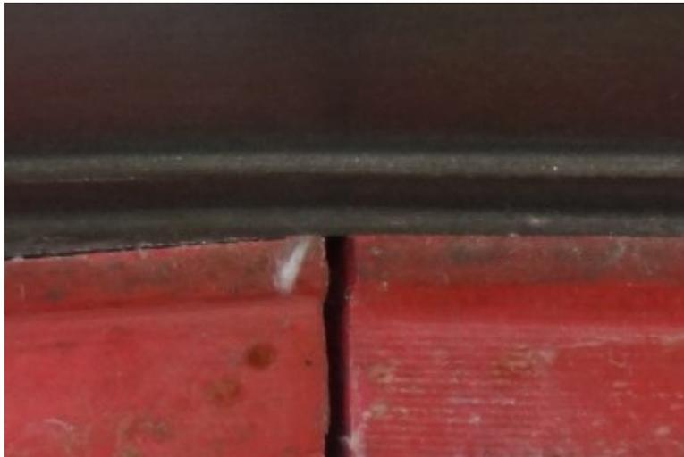
*Abbildung 71: Erforderliche Dehnfuge im kalten Werkzeug.*
