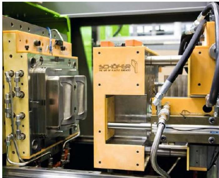
*Abbildung 19: Abbildung der zentralen Einbausituation des Mischkopfes sowie der notwendigen Isoliermaßnahmen auch zum Schutz der Hydraulikkomponenten vor thermischer Überbelastung [2].*
