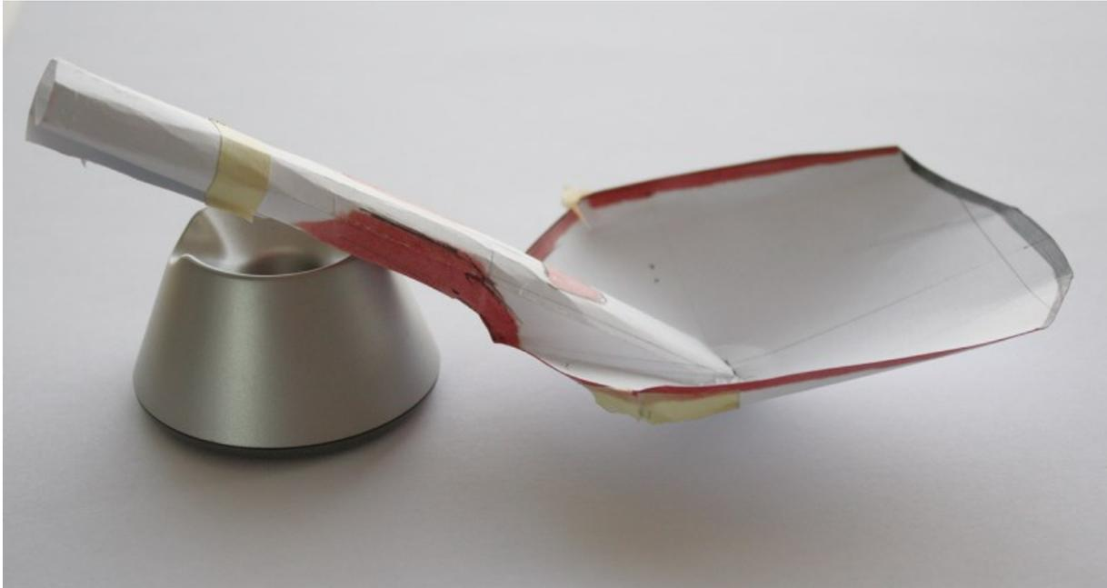
*Abbildung 81: Papiermodell zur Visualisierung der für das Gewebe drapierrelevanten Übergänge zwischen Stiel und Schaufelblatt.*
