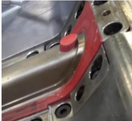
*Abbildung 75: Auswerfer mit Murseal Auswerferkopf.*
