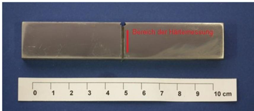
Abbildung 4.17: Ansicht einer Dreipunktbiegeprobe (SENB) mit eingezeichnetem Bereich der Härtemessung (Kapitel 4.5)
