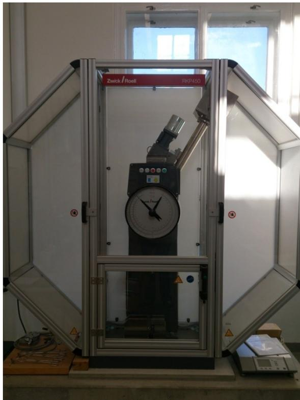
Abbildung 4.13: Pendelschlagwerk am Lehrstuhl für Umformtechnik an der Montanuniversität Leoben
