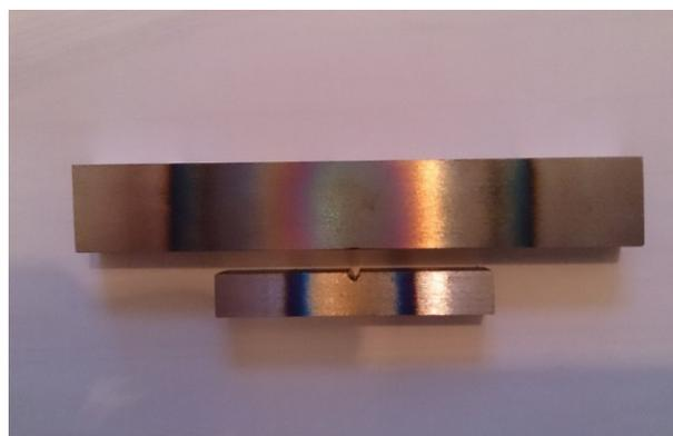
Abbildung 4.12: Wärmebehandelte Kerbschlagbiege- und Dreipunktbiege- (SENB) Probe
