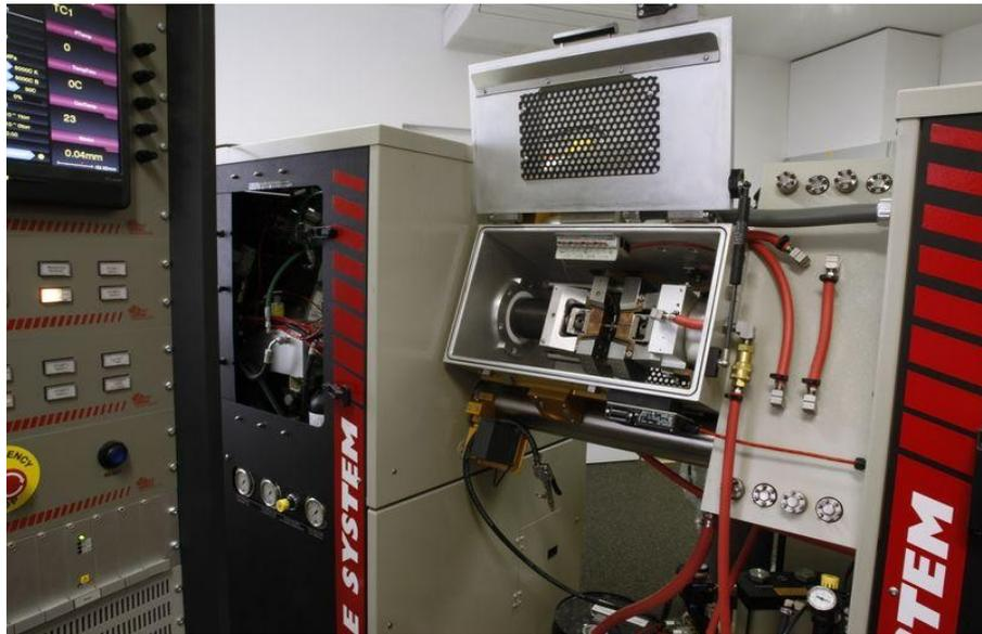
Abbildung 4.10: Ansicht der thermomechanischen Prüfmaschine Gleeble 3800
