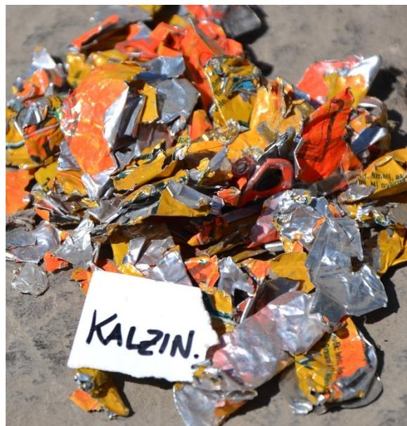
Abbildung 34: Nichteisen-Fraktion des Tracers im Produktstrom
