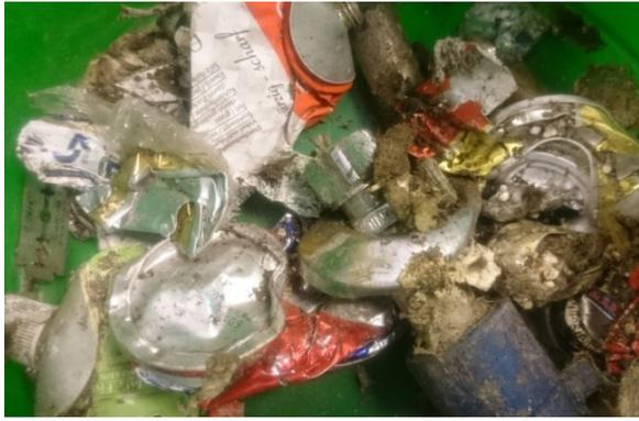
Abbildung 42: Metalle Siebdurchgang 30 mm
