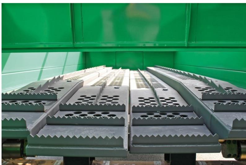
Abbildung 29: Paddel mit Siebplatten eines Ballistors der Komptech GmbH [1]
