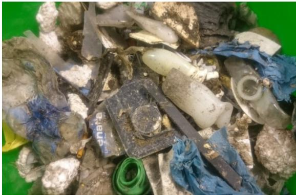
Abbildung 44: Kunststoffe Siebdurchgang 30 mm
