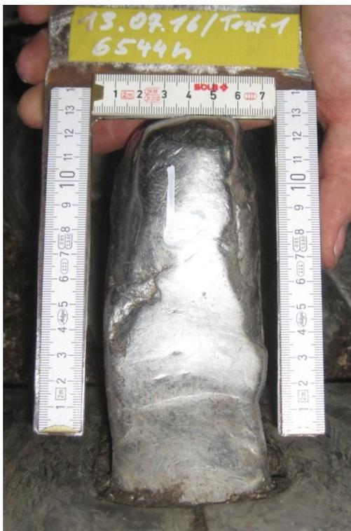
Abbildung 21: stark verschlissener Gegenkammzahn
