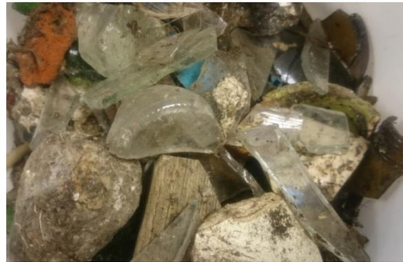
Abbildung 45: Inertstoffe Siebdurchgang 30 mm
