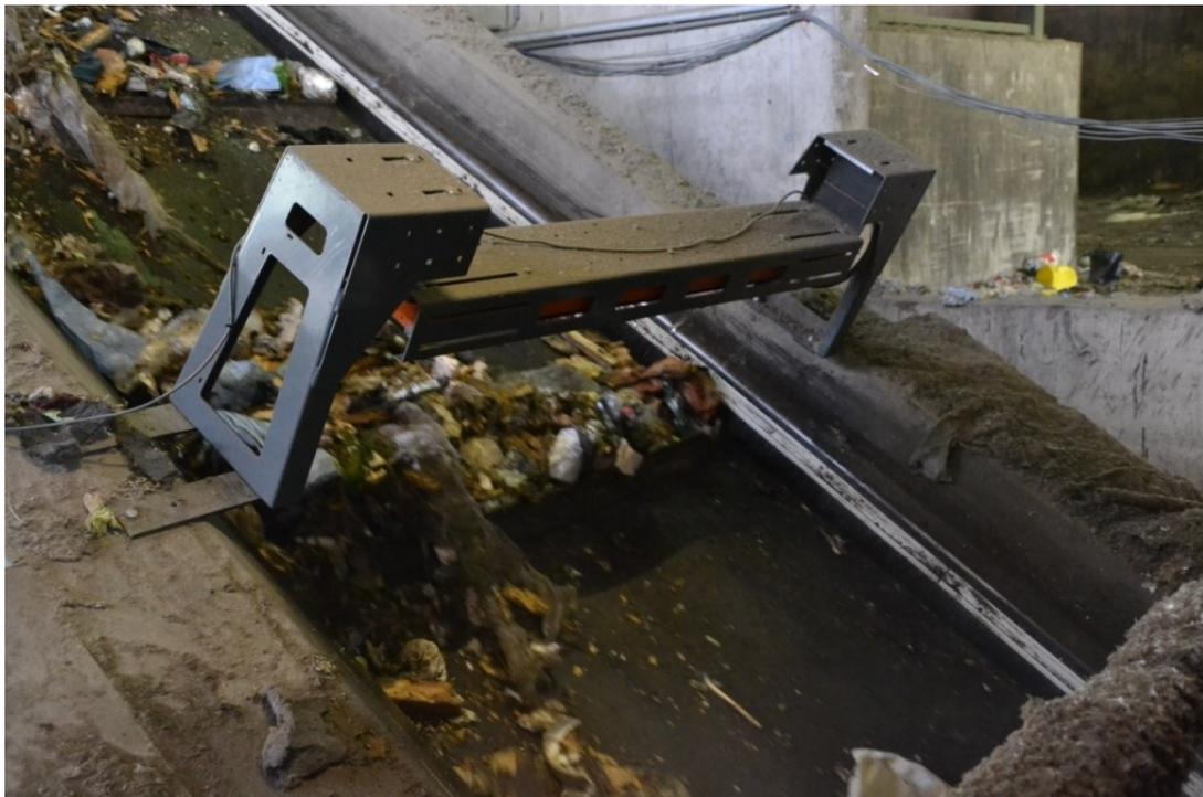
Abbildung 23: optische Messung des Volumenstromes
