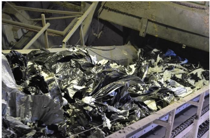
Abbildung 15: Kunststofffolien nach dem Vorzerkleinerer
