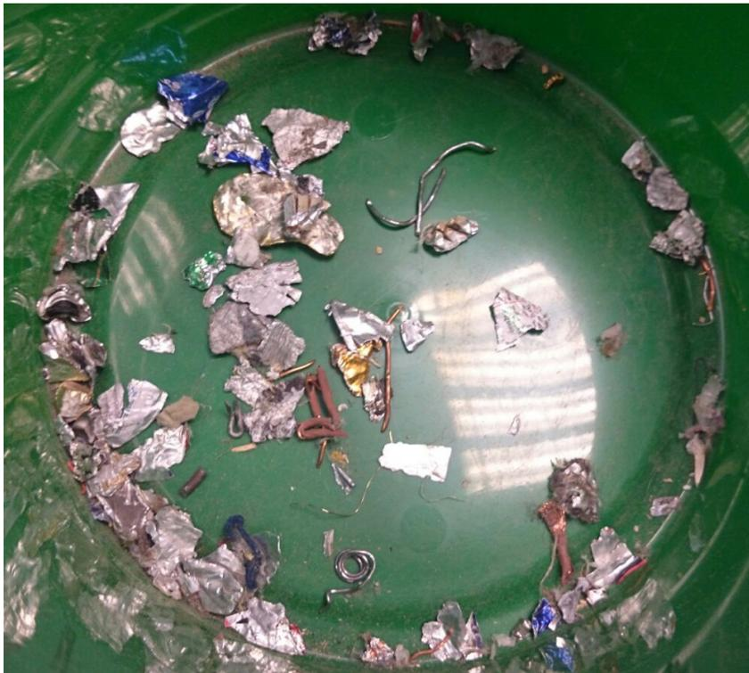
Abbildung 56: Sortierte Metall-Fraktion aus Mainburner
