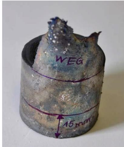
**Abbildung 3-6:** Markierungen für Trennung einer PlatiCast-Probe.
