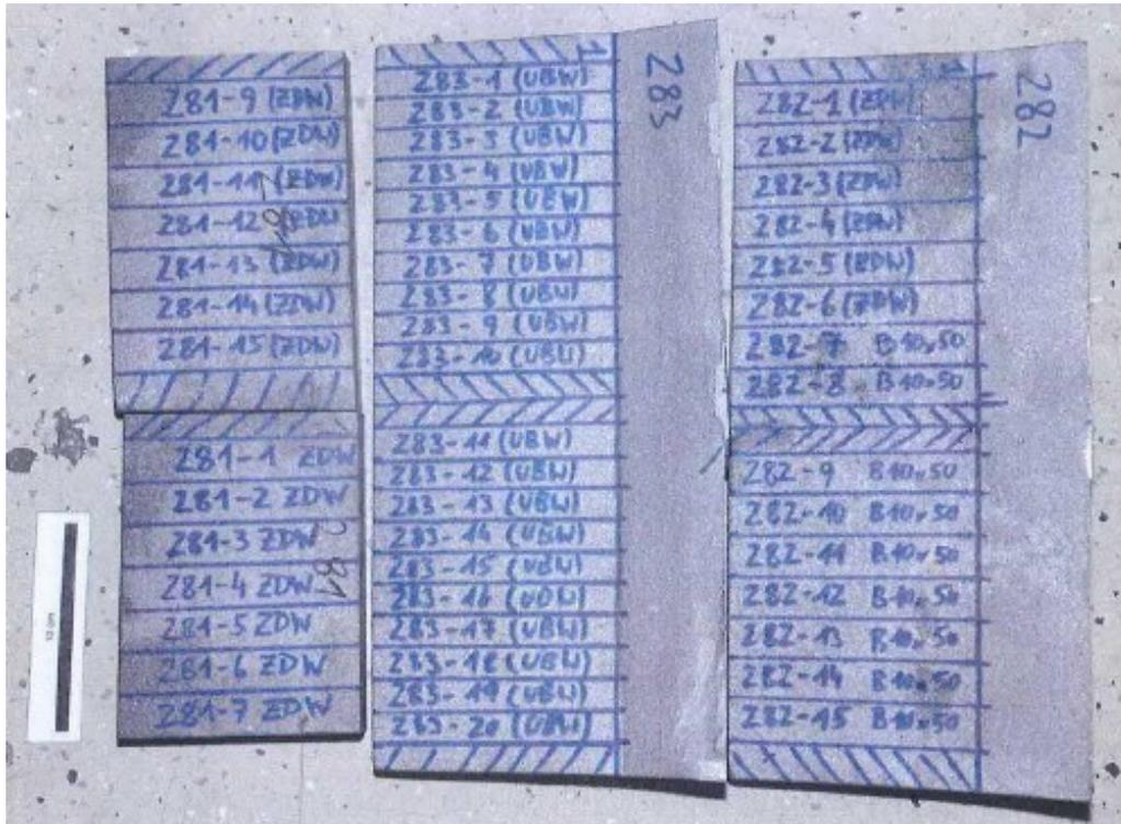
Abbildung 49: Kennzeichnung der Positionen der Prüflinge auf den Probenplatten (GJS 500-14).
