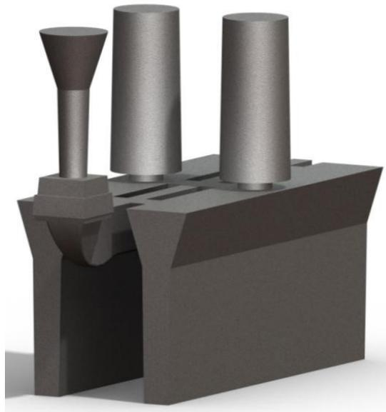
Abbildung 22: Probenplatten mit Speiser und Angussystem [26].
