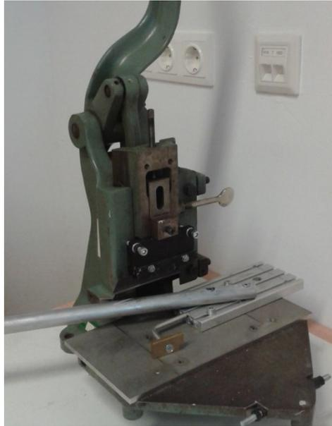
*Abbildung 32:Vorrichtung zum Schneiden des abgewickelten Schneckenkanals*
