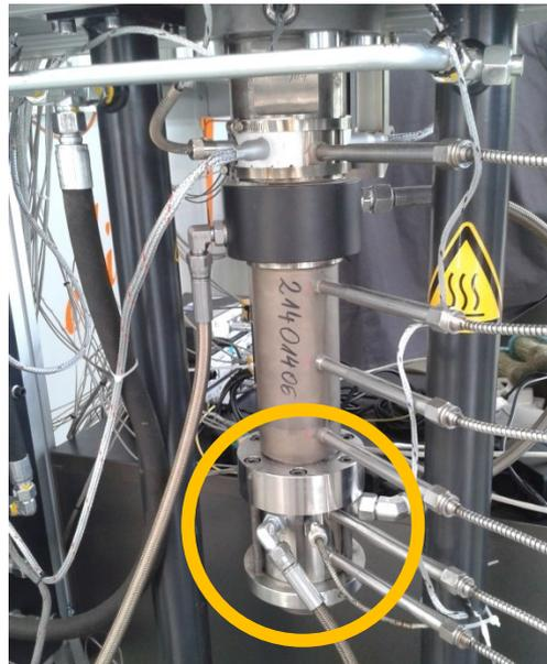
*Abbildung 15: Zylinder des Schneckenprüfstands mit Verlängerung für kernprogressive Schnecke*
