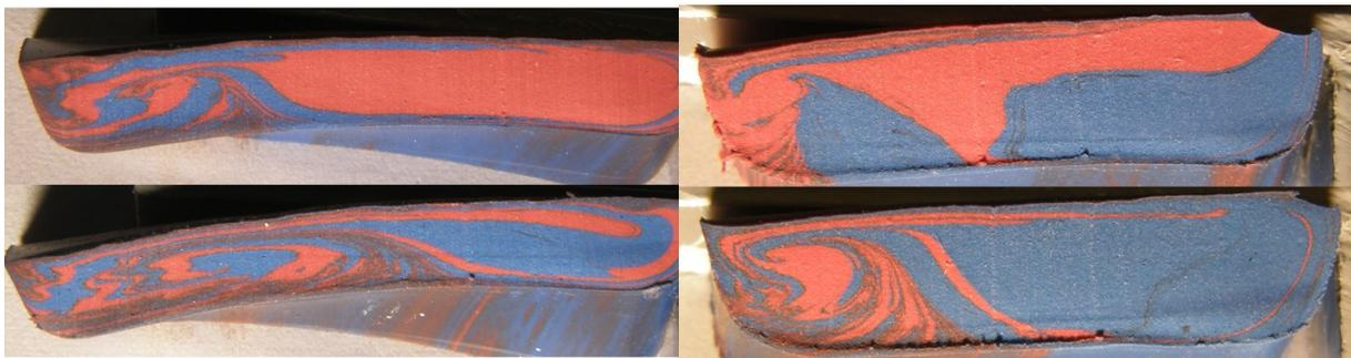
*Abbildung 60: Vergleich der Schnittbilder der MK-Schnecke (links) mit jenen der M1-Schnecke (rechts) an den Positionen 22,75 D (oben) und 27,25 D (unten), Tendenz der MK-Schnecke zu einer schnelleren vollständigen Ausbildung der Umlaufströmung, 60\_80\_90\_20*
