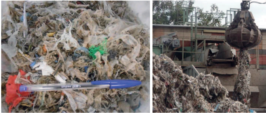
Abbildung 9: Links: separiertes Rejekt aus der Altpapieraufbereitung; Rechts: angelieferter Rejekt-Zopf beim Entsorger vor der Zerkleinerung
