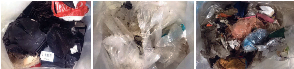
Abbildung 30: Darstellung des Probenmaterials von LVP 2 vor der Zerkleinerung: Links: Kunststoffemballagen und -behältnisse; Mitte: Kunststofffolien; Rechts: Leichtfraktion aus der Verpackungssammlung
