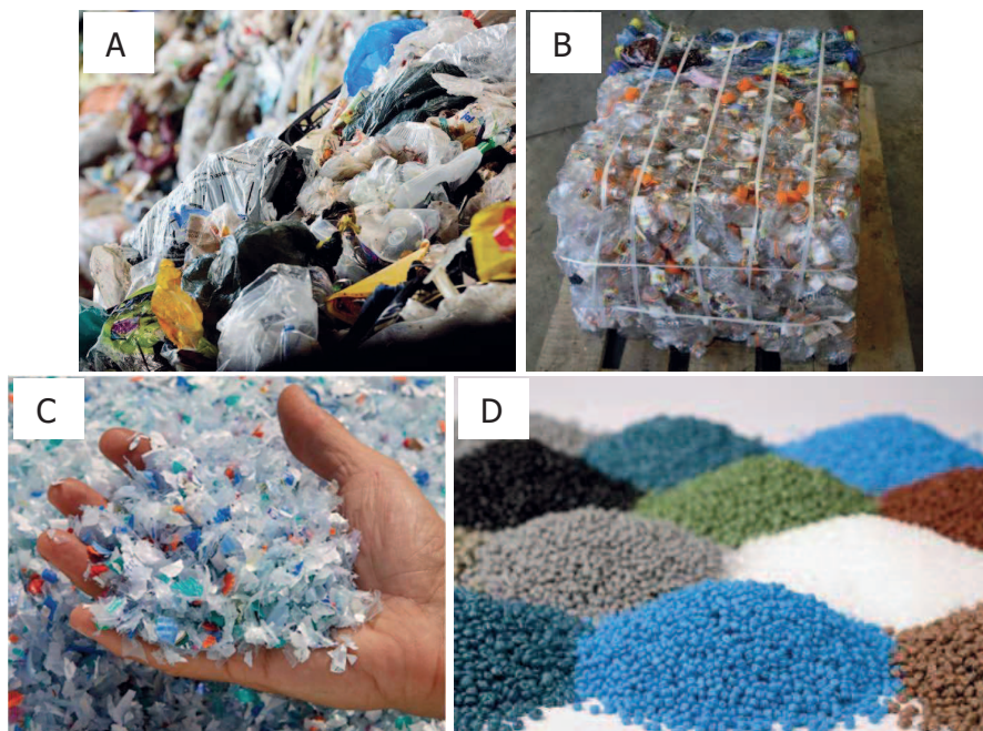
Abbildung 7: A: Leichtstoffverpackungsabfälle vor der Sortierung; B: Sortierte und verpresste Kunststoffe; C: Kunststoffflakes nach der Aufbereitung; D: Regranulate [25]
