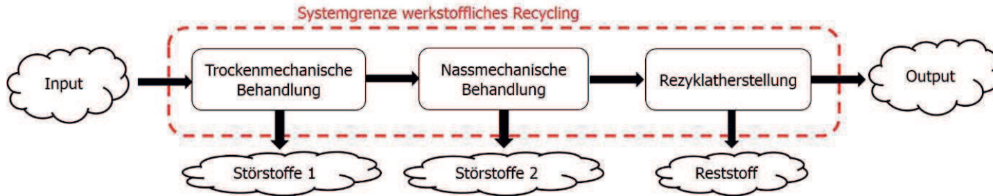
Abbildung 12: Verfahrensschema mit Systemgrenze für das werkstoffliche Recycling
