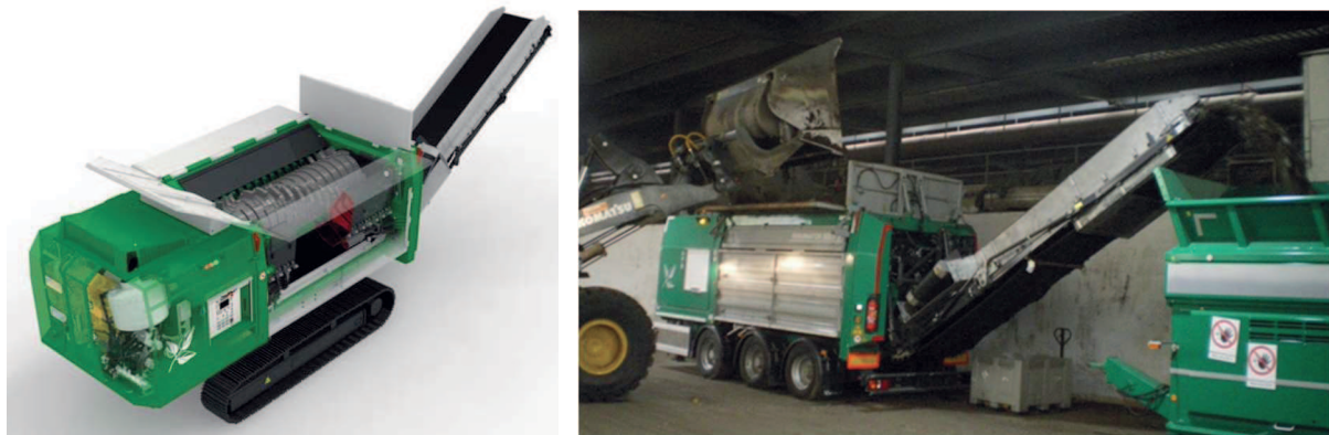
Abbildung 56: Links: Schematischer Aufbau des Einwellen-Zerkleinerers [69]; Rechts: Verwendeter Terminator der Firma Komptech GmbH zur Zerkleinerung Trommelsieb
