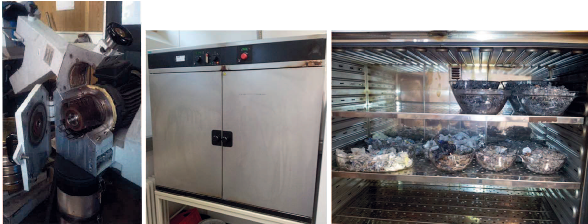
Abbildung 35: Vorbehandlungsschritte als Vorbereitung für die Schwimm-Sink-Sortierung: Links: Schneidmühle zur Probenzerkleinerung; Mitte: Trockenschrank geschlossen; Rechts: Innenraum des mit Proben gefüllten Trockenschanks
