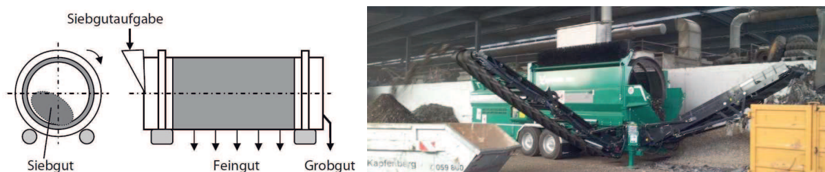
Abbildung 57: Links: Schematische Funktionsweise eines Trommelsiebes [8]; Rechts: Verwendetes Trommelsieb der Firma Komptech GmbH zur Abtrennung der Feinfraktion
