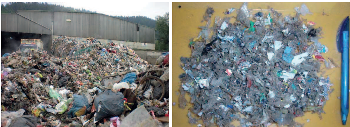
Abbildung 31: Links: Gemischte Siedlungsabfälle vor der Sortierung; Rechts: Aus diesem Abfallstrom erzeugter, zerkleinerter Ersatzbrennstoff (EBS)
