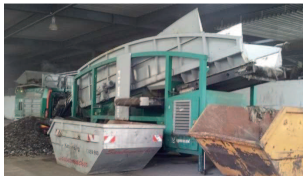
Abbildung 58: Links: Schematische Funktionsweise eines Ballistikseparators [70]; Rechts: Verwendeter Ballistor der Firma Komptech GmbH zur Abtrennung der 2D-Fraktion
