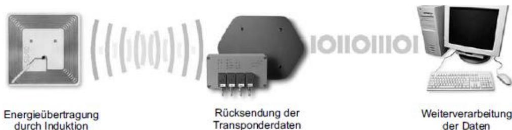
Abbildung 34: Aufbau eines RFID Transpondersystems<sup>329</sup>
