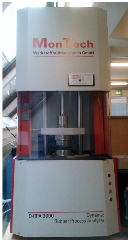
Abbildung 19: Vulkameter MonTech D-RPA-3000 und schematische Skizze der bikonischen Prüfkammer
