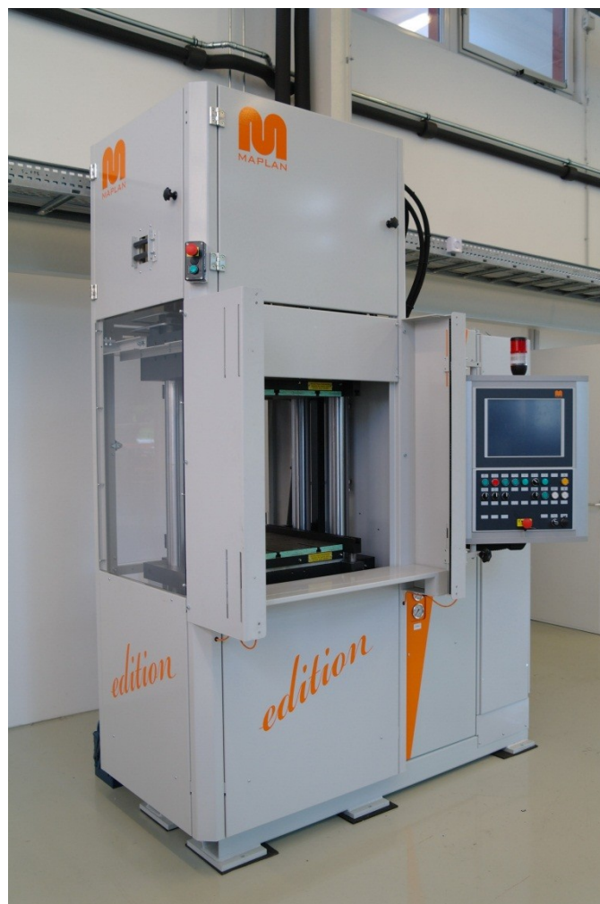
Abbildung 32: Elastomerspritzgießmaschine Maplan MTF 750/160 edition [14]
