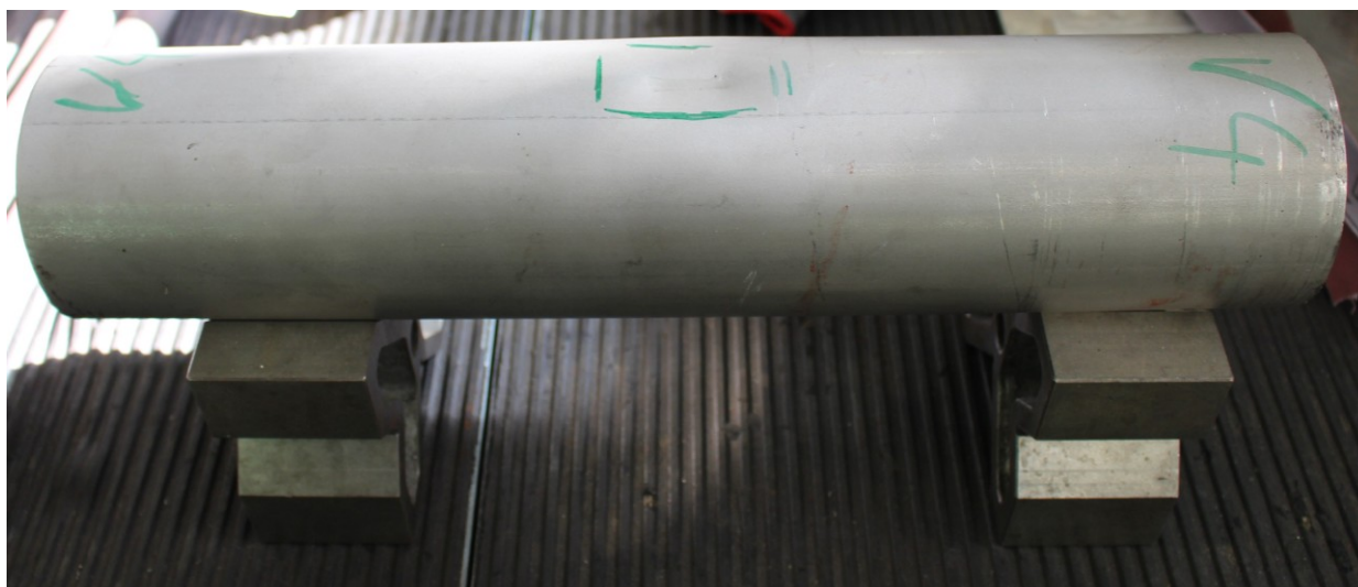
Abbildung 44: Rohr des Versuches V4 auf zwei Messprismen.
