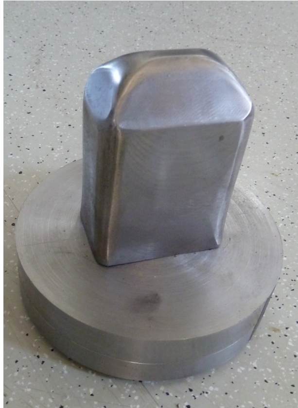
Abbildung 36: Der für die Versuche verwendete Eindringkörper.
