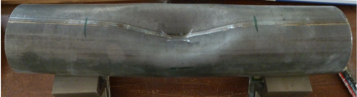
Abbildung 48: Einbeultes Rohr mit deutlich zu sehenden Riefen.
