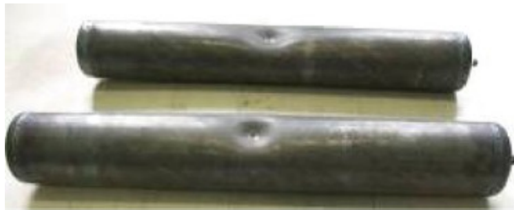
Abbildung 31: Die eingebeulten Druckkesseln von M. Allouti [5].
