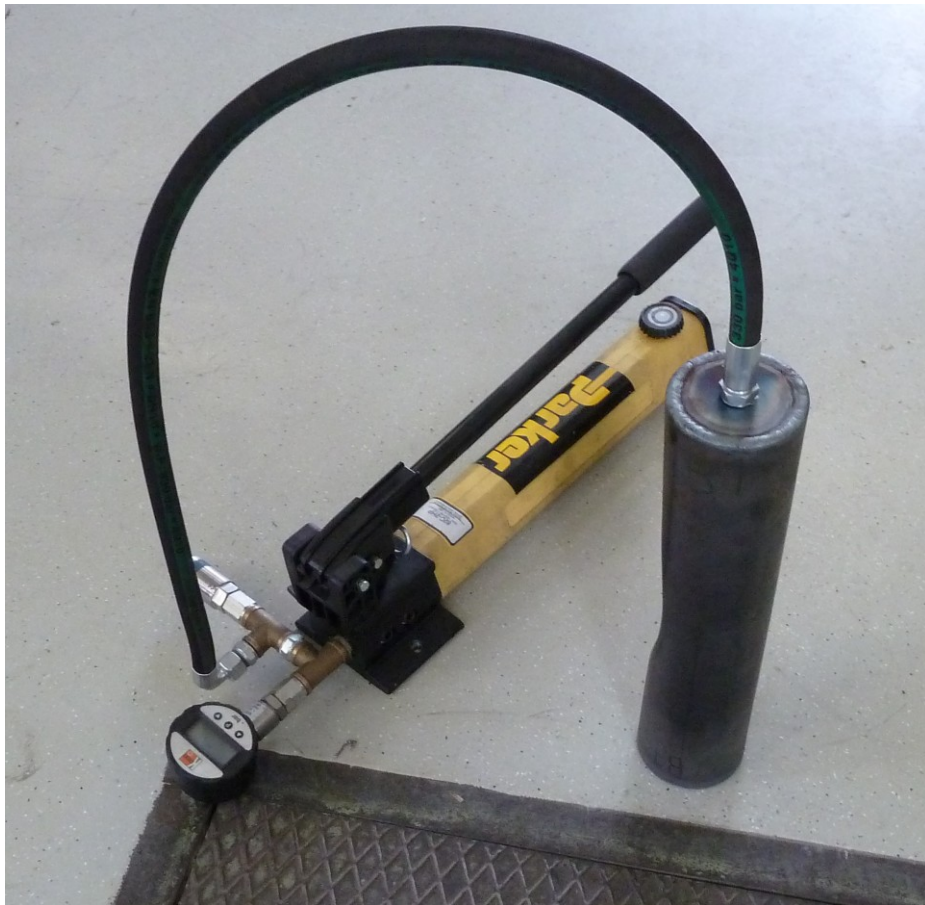
Abbildung 51: Versuchsaufbau für den Druckversuch.
