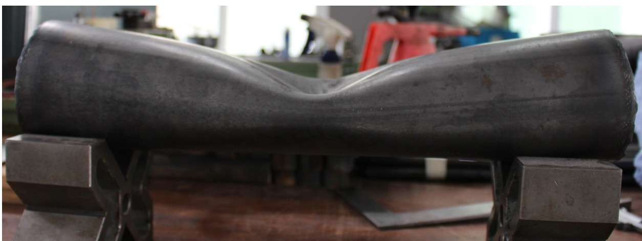
Abbildung 63: Das gefaltete Rohr des Quetschversuches.
