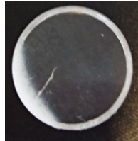
Abbildung 20: KBr-Pressling mit Riss.
