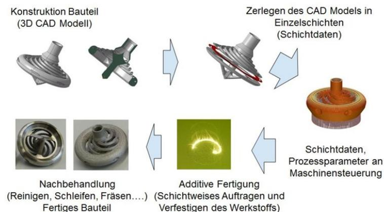
**Abbildung 2.2:** Herstellung additiv gefertigter Bauteile [8]
