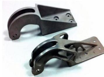
**Abbildung 2.9:** L-PBS-Verfahren hergestelltes Scharnier [12]
