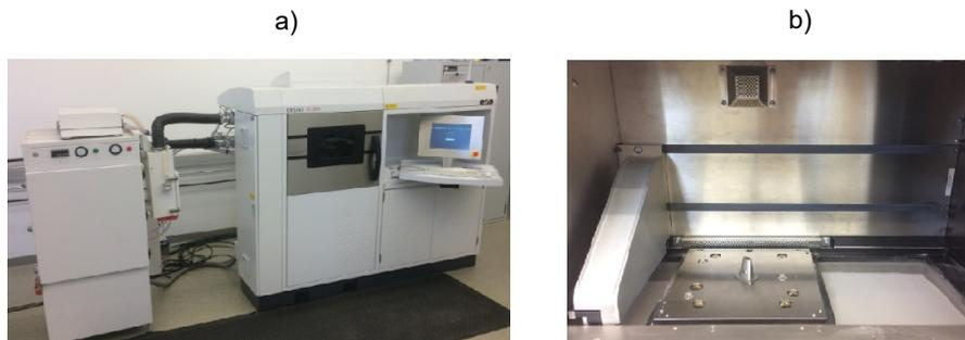
**Abbildung 3.5:** Laserstrahl-Pulverbettsschmelzanlage EOSINT M280 a) Anlage, b) Prozesskammer
