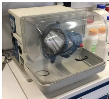
**Abbildung 3.4:** Mischvorgang mittels Tumbler Mischer
