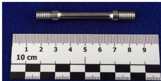
**Abbildung 3.6:** Zugprüfkörper aus L-PBF-Verfahren nach DIN 50125
