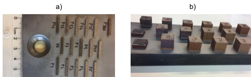
**Abbildung 4.16:** a) Schweißbahnen und b) Testquader der Charge 4
