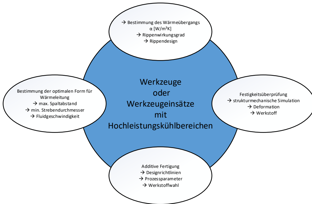
Abb. 3.35: Themenschema für die Entwicklung von additiv gefertigten Hochleistungskühlereinsätzen für den Werkzeugbau
