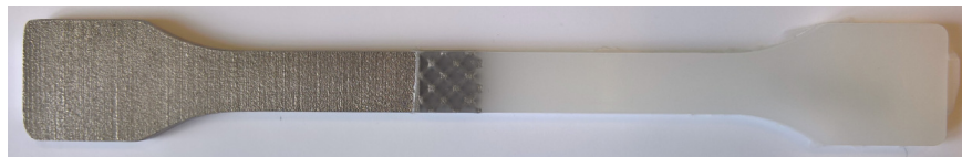
Abb. 4.16: Fertige Zugprobe mit Hybridverbindung zwischen Metall und Kunststoff
