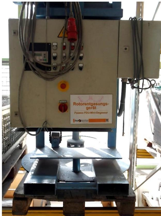
Abbildung 3-5: Rotorentgasungsgerät zur Schmelzereinigung am ÖGI.
