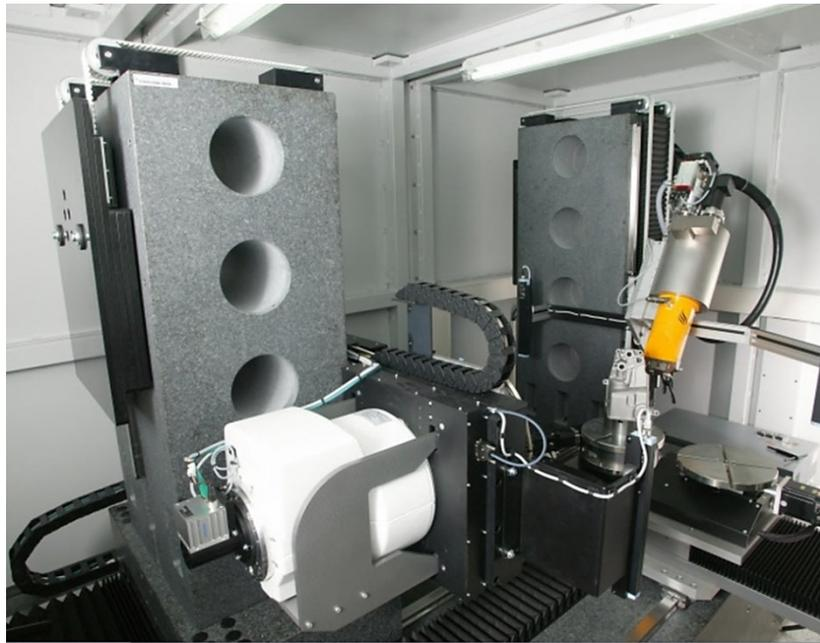
Abbildung 3-2: Übersicht des Prüfraums der CT-Anlage mit Detektor (Bild Mitte), eingespanntem Objekt am Drehtisch und Röntgenröhre (rechts) am ÖGI.
