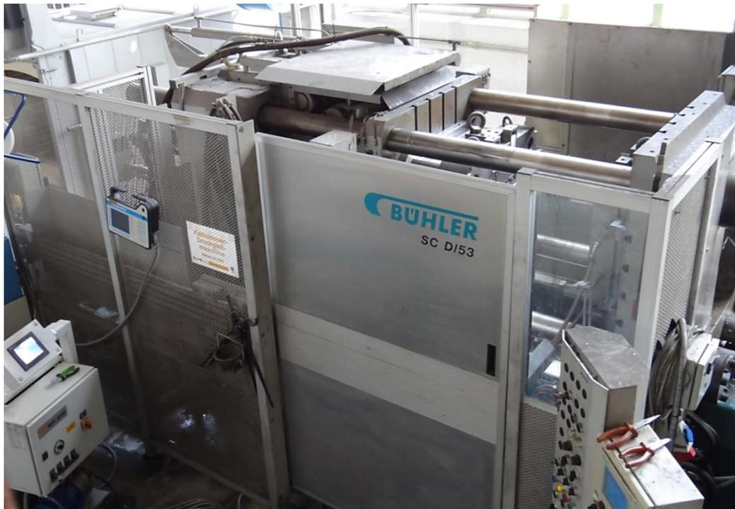
Abbildung 3-7: Kaltkammer-Druckgießmaschine Bühler SC D/53 am ÖGI.
