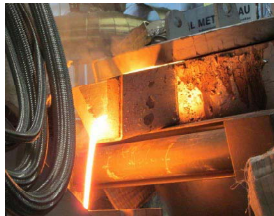
(b) Schlackenstrom in Rinne
