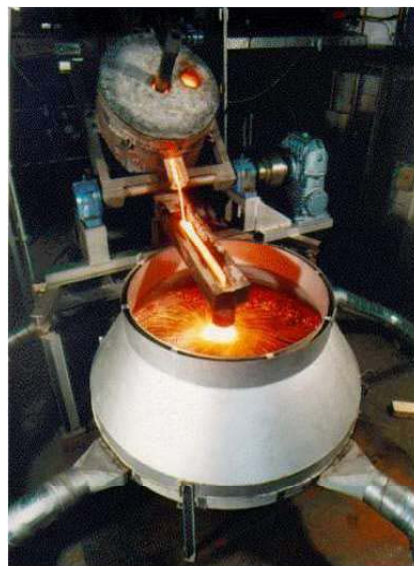
Abbildung 4.19.: Siemens Vorversuche zur trockene Granulation von Hochofenschlacke in Vitkovice (CZ) [53]
