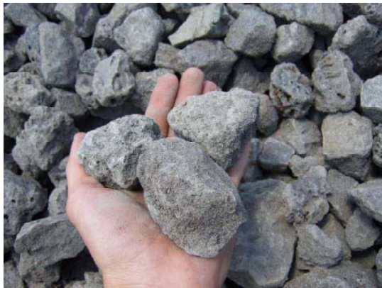
(a) Gleisschotter 0/63 mm
