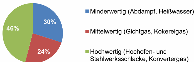
Abbildung 2.4.: Ungenutzte Energiereserven nach Aufteilung in drei Temperaturbereiche der Eisen- und Stahlindustrie am Beispiel Chinas nach [8]
