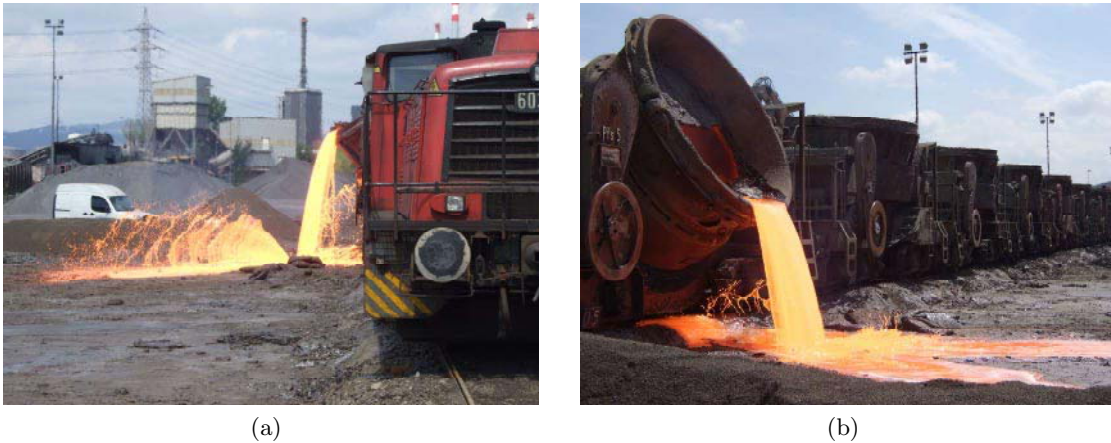
Abbildung 3.6.: voestalpine Stahl GmbH in Linz – Schlackenbeete
