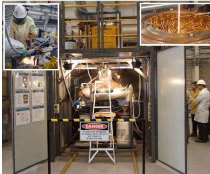
Abbildung 4.14.: Versuchsanlage (SDA) mit einem Durchmesser von 1,2 m und einer Schlackenrate von 10 kg/min der CSIRO [51]
