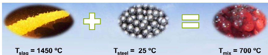
Abbildung 4.1.: Grundprinzip der Festkörperabkühlung der Firma Paul Wurth zur Energierückgewinnung aus schmelzflüssiger Hochofenschlacken [44]
