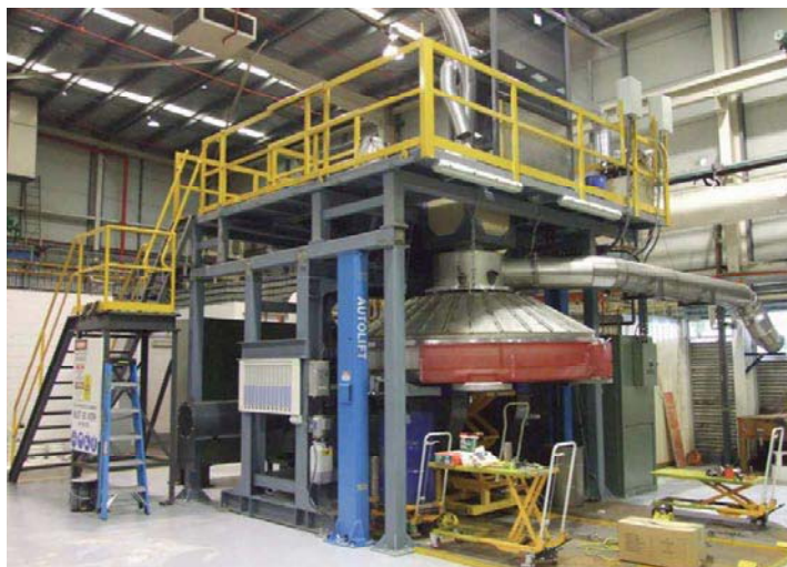
Abbildung 4.15.: Versuchsanlage (SDA) mit einem Durchmesser von 3 m und einer Schlackenrate von 100 kg/min der CSIRO [52]
