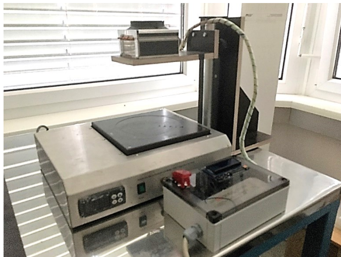
Abbildung 68: Nachhärtungs Apparatur mit Heizplatte.
