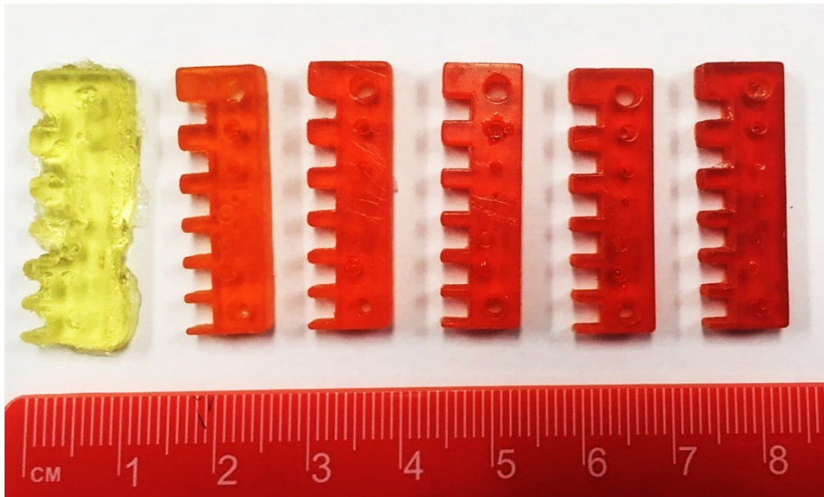
Abbildung 49: Druckergebnisse mit steigendem Sudan II Mengenanteil von links nach rechts.
