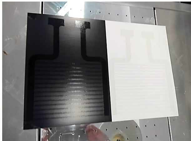
Abbildung 75: Druckbild des eingedickten Siebdrucklacks vor der Trocknung auf schwarzem, Kunststoffbeschichtetem und weißem unbeschichtetem Papiersubstrat.
