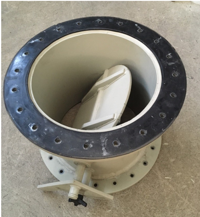
Abbildung 19: Ausgebaute Drosselklappe vor dem Gebläse
