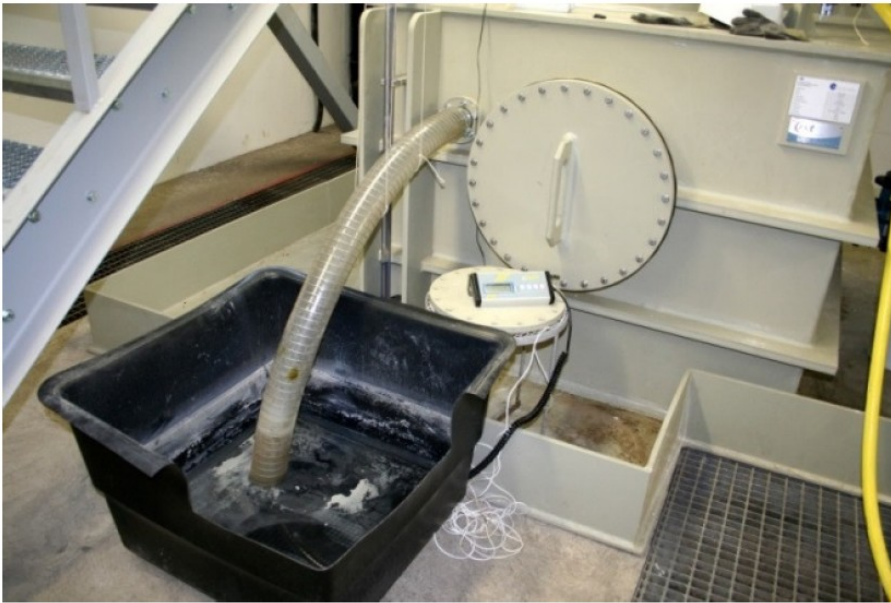
Abbildung 12: Messmethode für den Hold-up 2014
