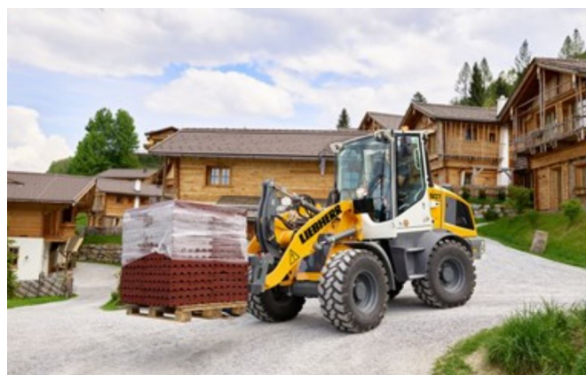
Abbildung 9: Radlader mit Ladegabel als Arbeitsausrüstung (LBH)
