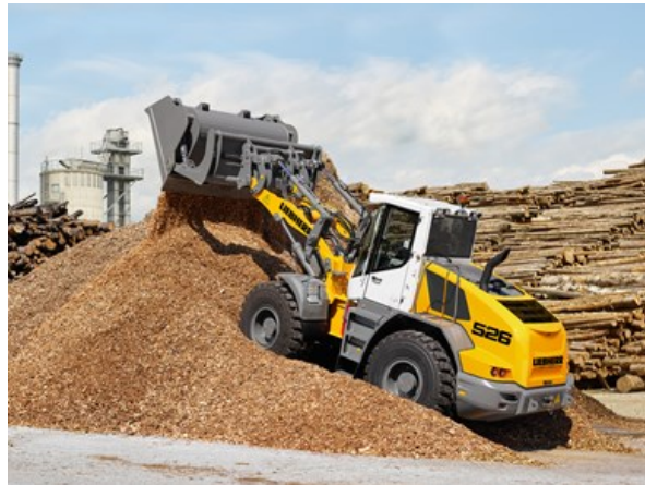
Abbildung 8: Radlader mit einer Hochkippschaufel als Arbeitsausrüstung (LBH)
