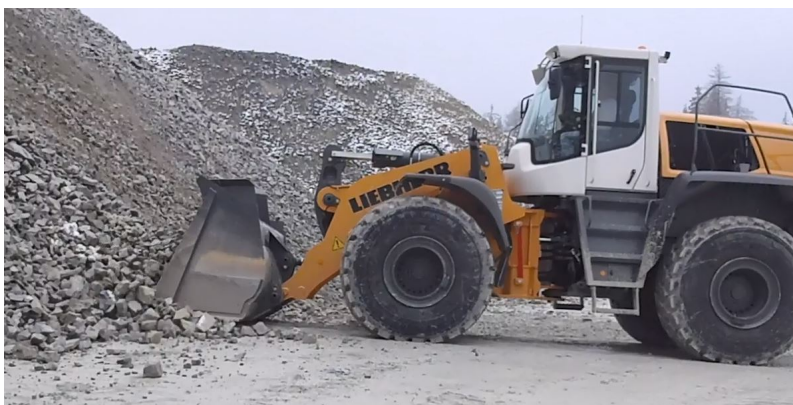
Abbildung 64: Startposition für den Test der unterschiedlichen Steuerungsmethoden der Hydraulikzylinder
