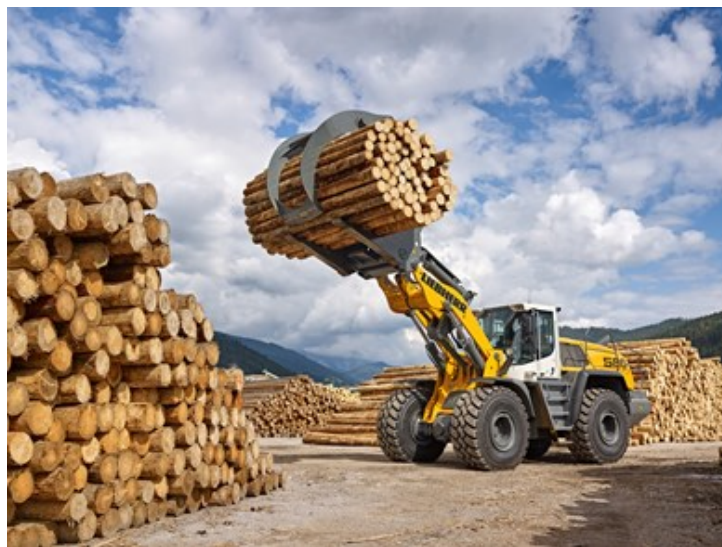
Abbildung 10: Radlader mit einem Holzgreifer als Arbeitsausrüstung (LBH)
