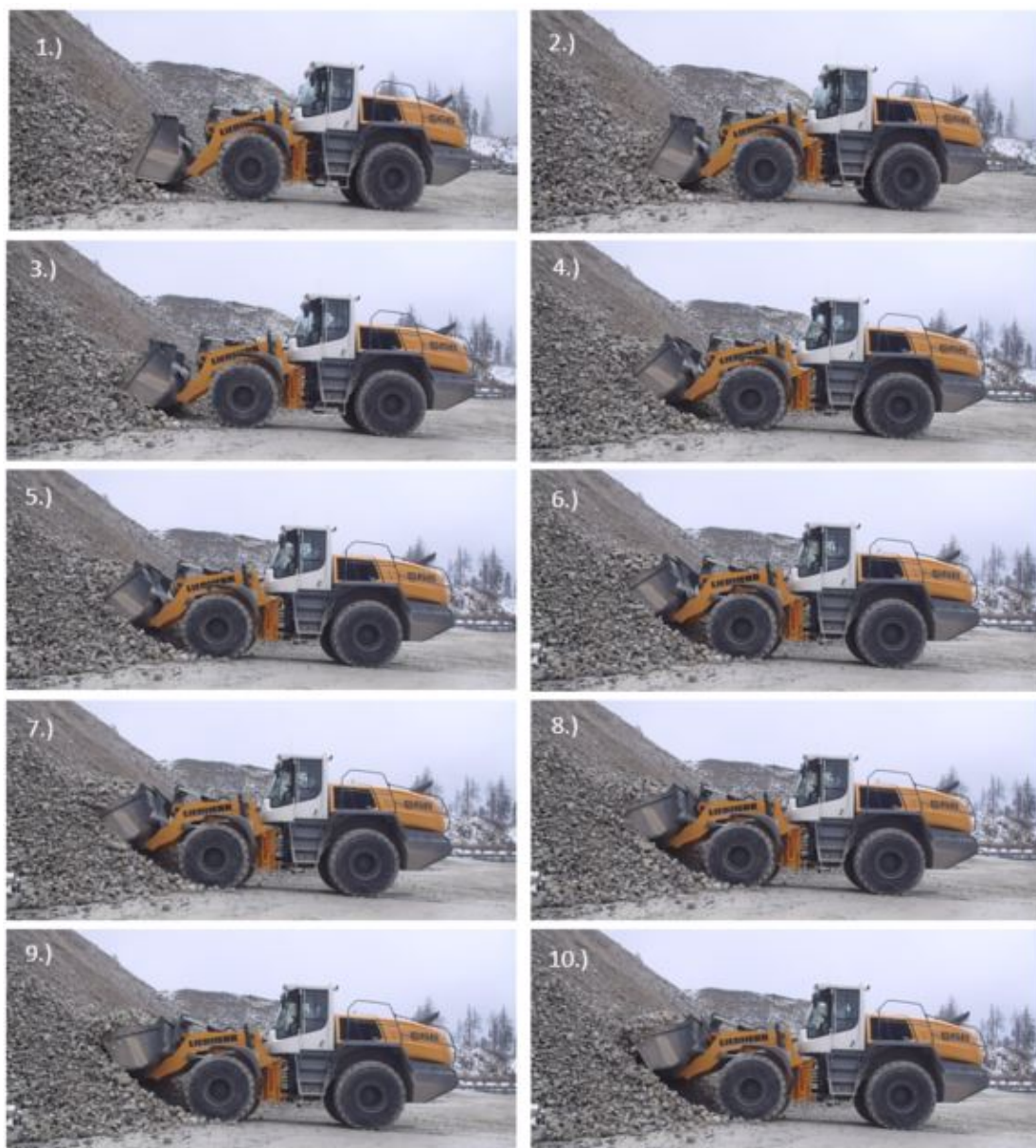
Abbildung 42: Ladevorgang eines Radladers (Quelle: LBH)
