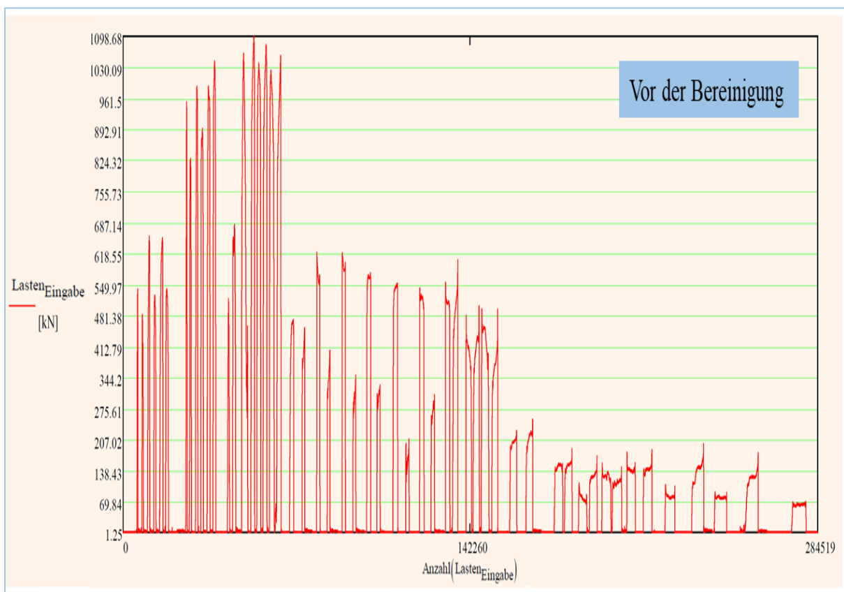
Abb. 5.9 Kraftverlauf vor der Bereinigung
