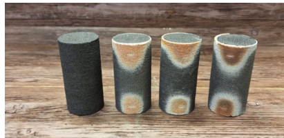
Abbildung 34: Glühverlust bei den DKV, v.l.n.r.: ungetestet, 1300 °C, 1400 °C, 1500 °C
