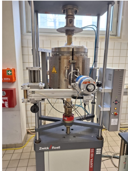
Abbildung 36: Druckkriechprüfmaschine während der Aufheizphase
