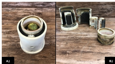
Abbildung 35: A.) Versuchsaufbau vor dem Test; B.) Verwendete Versuchsaufbauteile; vergleich hierzu Abbildung 11 - den schematischen Versuchsaufbau
