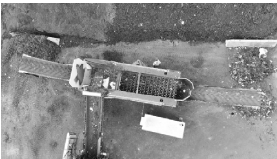
Abb. 2: Sternsieb „Multistar One“ im Einsatz. Mit Kunststoffen belastetes Überkorn geht nach rechts, entfrachtetes Unterkorn geht nach links
