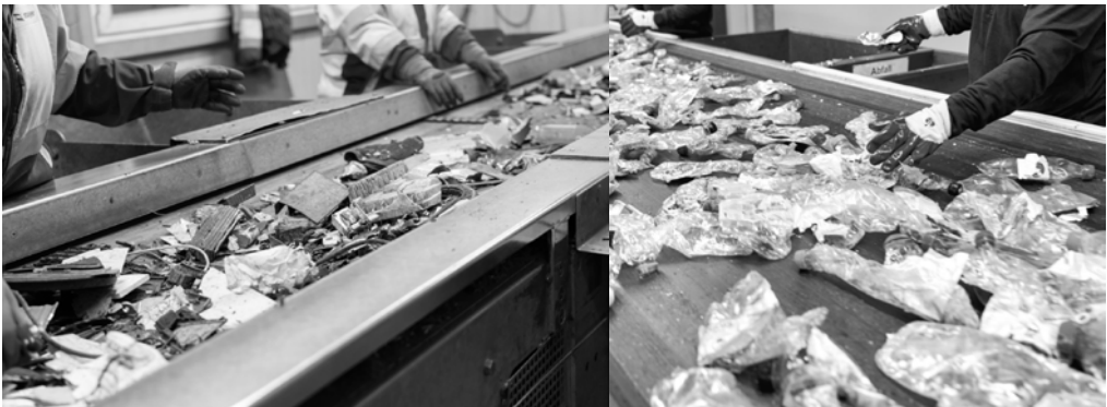
Abb. 1: Händische Sortierung von Abfällen, links Sortierung von vorzerkleinerten Elektroaltgeräten, rechts Sortierung von Kunststoffen
