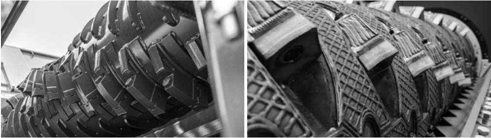
Abb. 3: Zerkleinerungswalze des Vorzerkleinerers (links) und Nachzerkleinerers (rechts) (Komptech, 2023; Untha, 2024)
