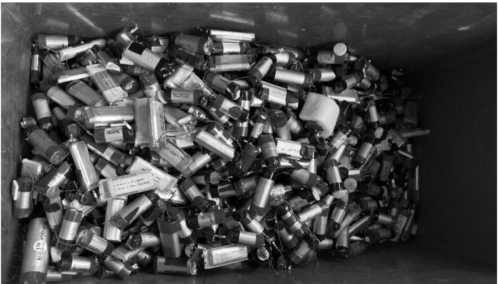
Abb. 2: Batterien aus Einweg-E-Zigaretten
