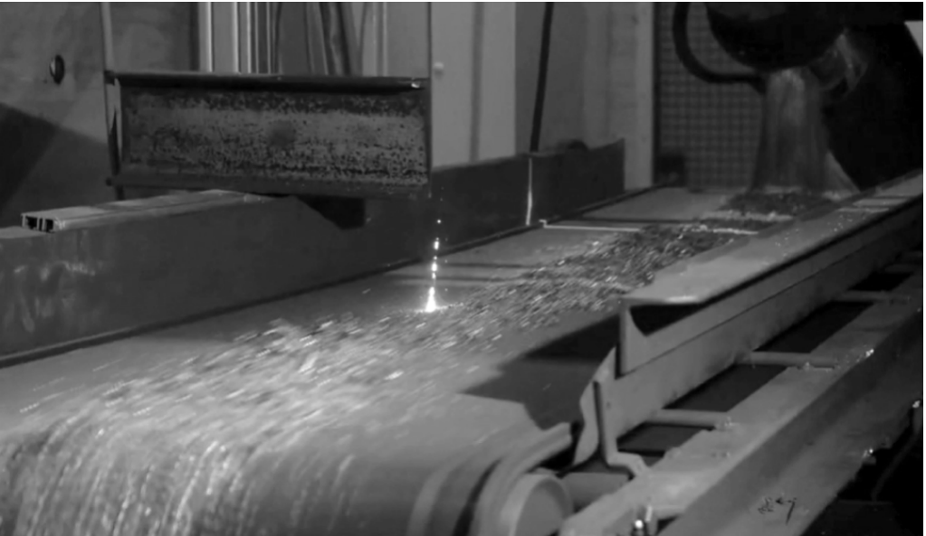
Abb. 4: 3D-Messung und Laser-Analyse an kleinen Stückgütern auf einem Förderband (EU-Projekt REVAMP 2020)
