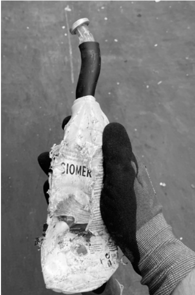
Abb. 2: Beispiel einer stark störenden Verpackung: eine weiße HDPE Flasche mit einem schwarzen Elastomerschlauch, der sich in der Flasche befindet
