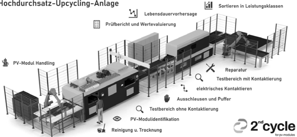
Abb. 1: Hochdurchsatz Upcycling-Anlage für gebrauchte PV-Module
