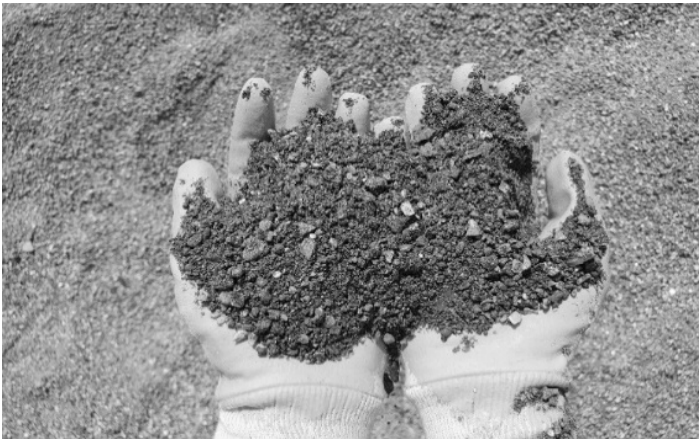
Abb. 2: industriell aufbereitete Gesteinskörnung „slagtory“ der Fa. Brantner
