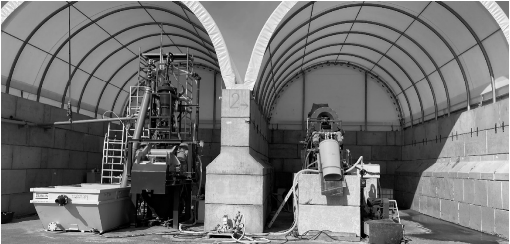
Abb. 2: Technikumsanlage für Bodenwaschversuche
