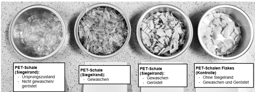
Abb. 2: Ergebnisse der Wasch- und Röstversuche des PET-Schalen-Siegelbereiches einer PET-Schale. Die Flakes beschrieben von links nach rechts, zeigen die PET Flakes des Siegelrandes im Ursprungszustand, nach dem Waschprozess (80°C, 15 Minuten, 600 rpm, NaOH und Waschtensid Lösung) und nach dem Rösten bei 220°C für 1 Stunde. Zum Vergleich werden rechts die PET-Flakes der Verpackung ohne Siegelbereich abgebildet, welche nach dem Waschen und Rösten keine braune Verfärbung aufweisen.
