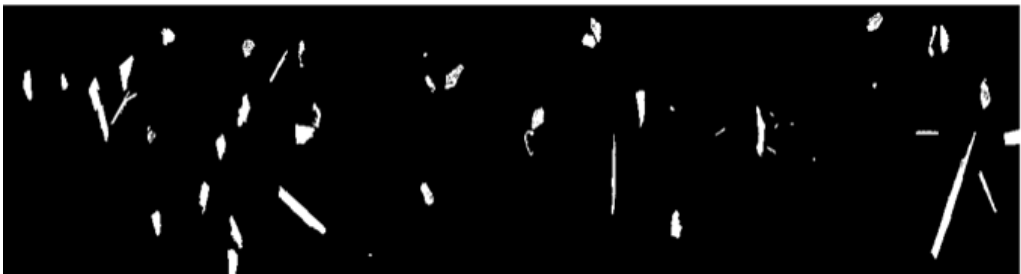
Abb. 3: Beispiel einer NIR-Aufnahme einer Holzfraktion
