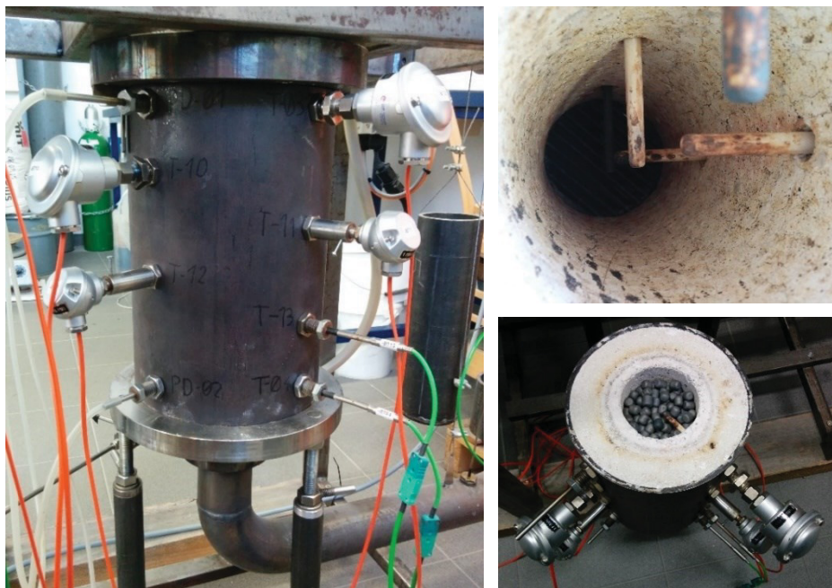
Abbildung 2: Pellet-Pot – links: Reaktionsraum von außen, rechts: Reaktionsraum leer und befüllt
