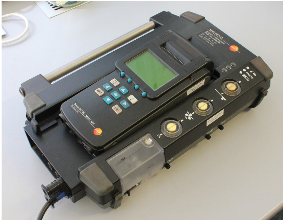
Abbildung 26: Gasmessung – Gasmessgerät (testo 350 XL)
