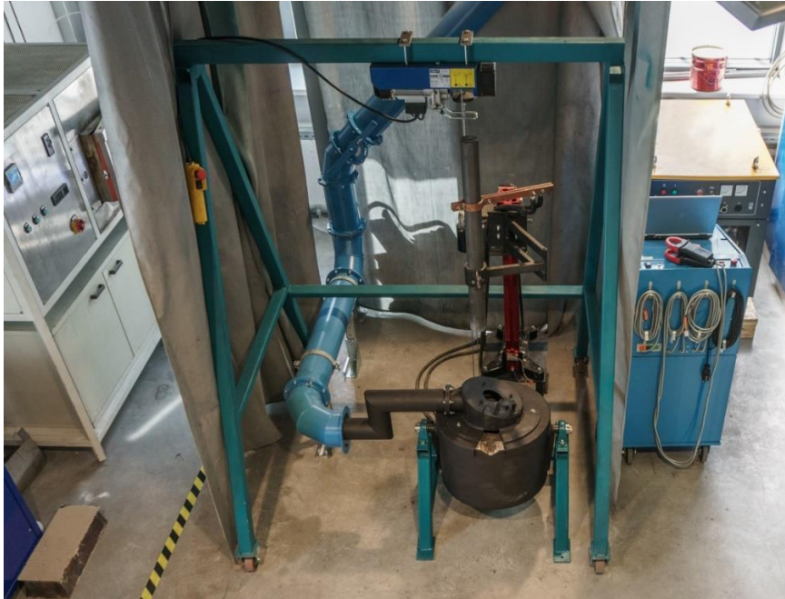
Abbildung 30: Lichtbogenofen am Lehrstuhl für Nichteisenmetallurgie [43]
