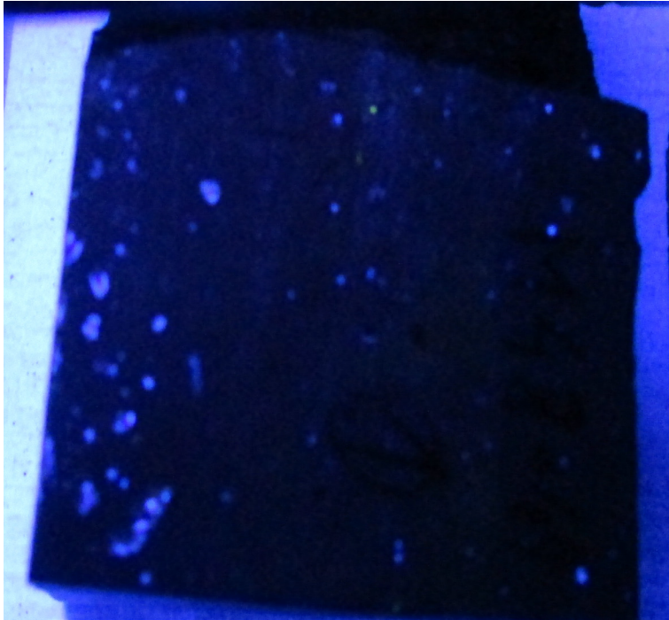
Abbildung 181: UBS 2, Blaufärbung in den Luftporen, Prismenbreite: 4cm
