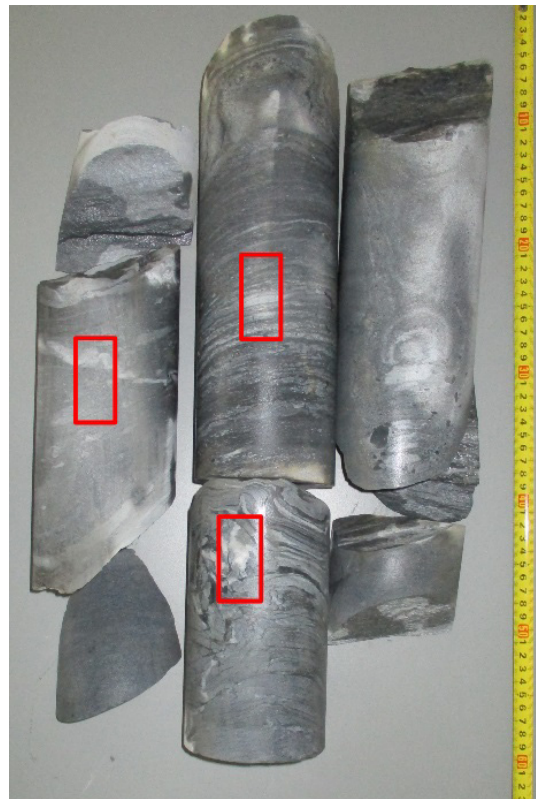
Abbildung 105: Kernmaterial OBS 2, Dünnschliffe wurden aus den rot umrandeten Bereich hergestellt.
