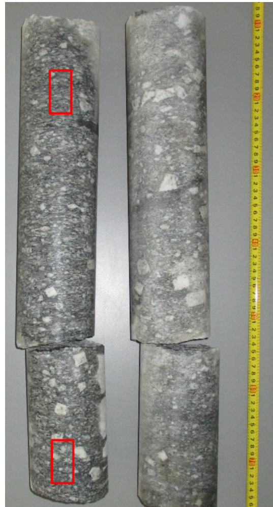
Abbildung 162: Kernmaterial AG, Dünnschliffe wurden aus dem rot umrandeten Bereich hergestellt.
