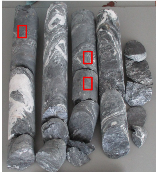
Abbildung 44: Kernmaterial UBS 3, Dünnschliffe wurden aus den rot umrandeten Bereichen hergestellt.
