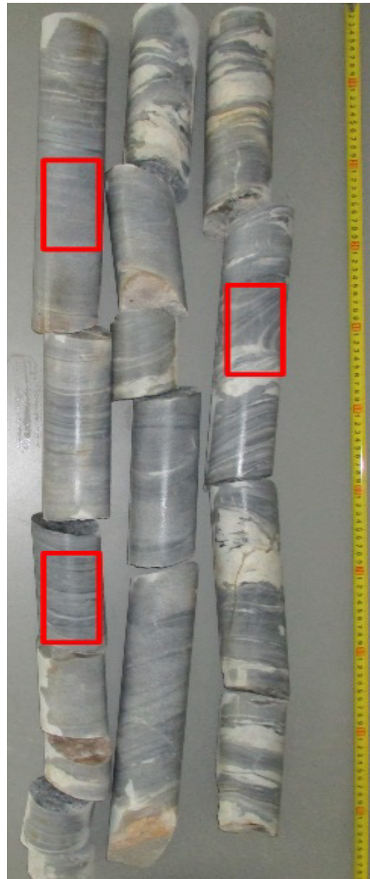
Abbildung 132: Kernmaterial HM 2, Dünnschliffe wurden aus den rot umrandeten Bereich hergestellt.
