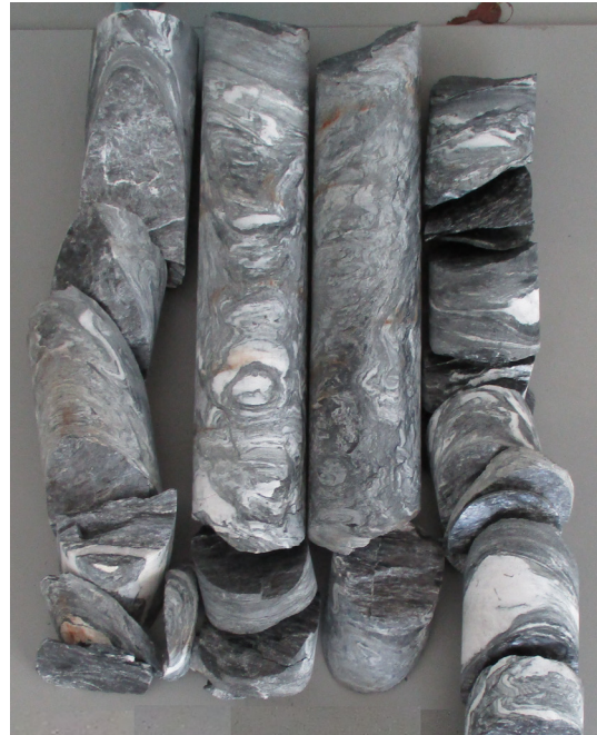
Abbildung 15: Kernmaterial UBS 1, Dünnschliffe wurden aus dem rot umrandeten Bereich hergestellt.
