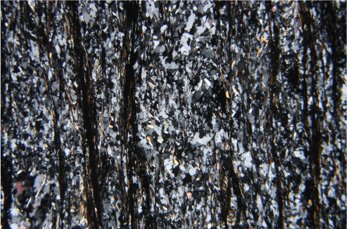
Abbildung 24: Feinkörniger Quarz mit Scherbänder, BB: 4mm
