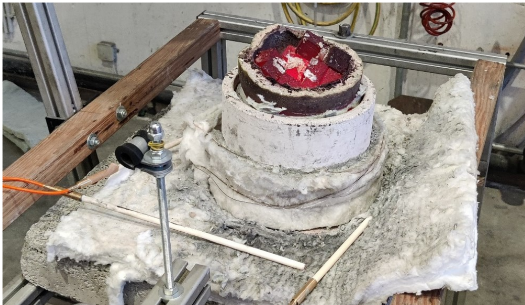
Abbildung 50: Der abgebrochene Tiegelboden des NMC_S1_30-Versuchs
