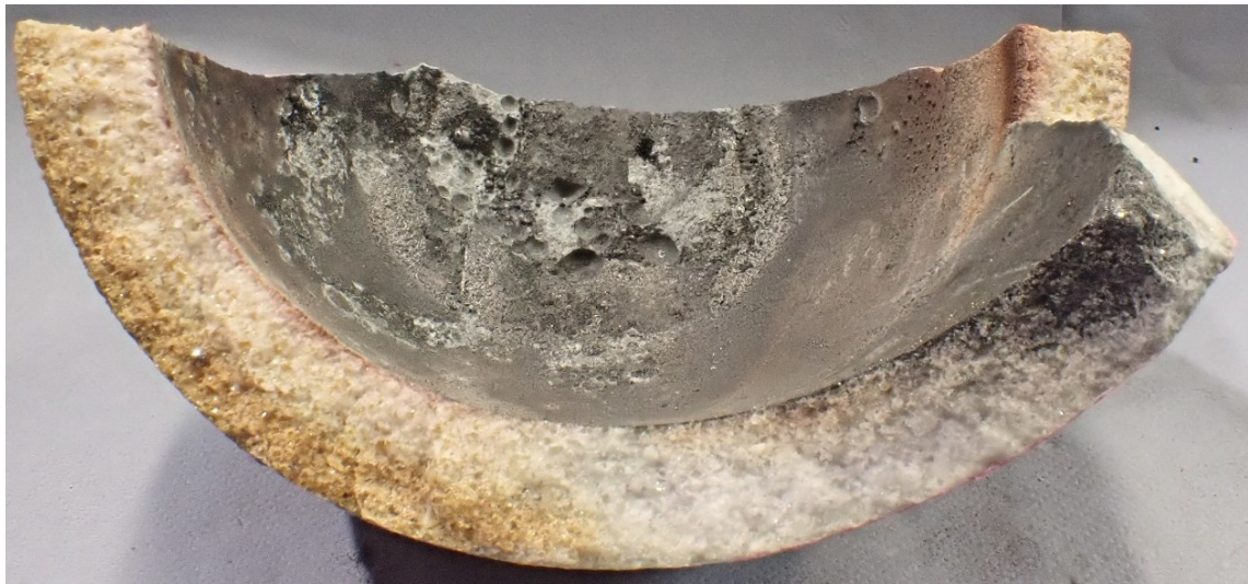
Abbildung 53: Anzeichen von Diffusion in den MgO-Tiegel anhand des NMC_S2_20-Versuchs
