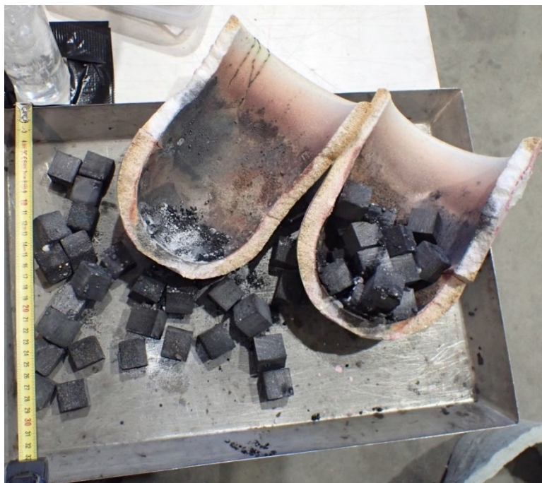
Abbildung 52: Bruchstelle des NMC_S2_20-Versuchs während der Probenaufbereitung
