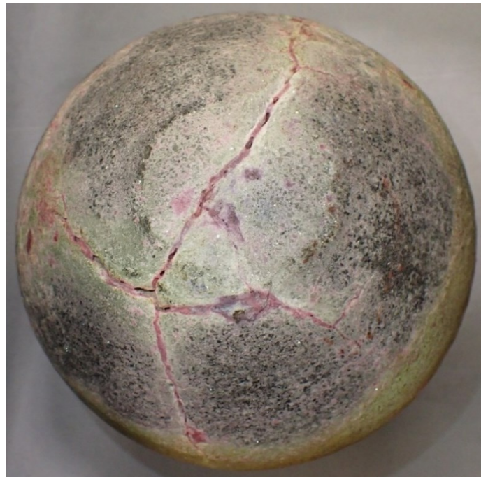
Abbildung 51: Risse im Boden des NMC_Ref-Versuchs
