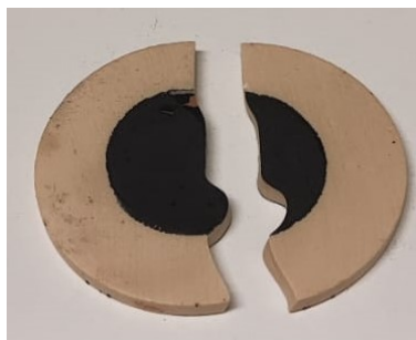
Abbildung 61: Gebrochene Zelle S041 nach dem Sintervorgang.
