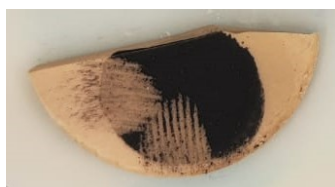
Abbildung 39: Zellbruchstück mit Stromsammler-Schicht aus LNF & AK gesintert bei 1100°C.
