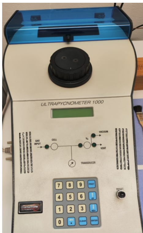
Abbildung 30: Helium-Pyknometer zur Bestimmung der Dichte von LPNSGCN.
