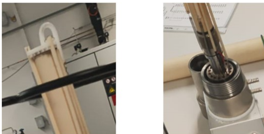
Abbildung 26: Links: Zellfixierung und Gaszuleitung, Rechts: Sockel mit Pins und Spannfedern.
