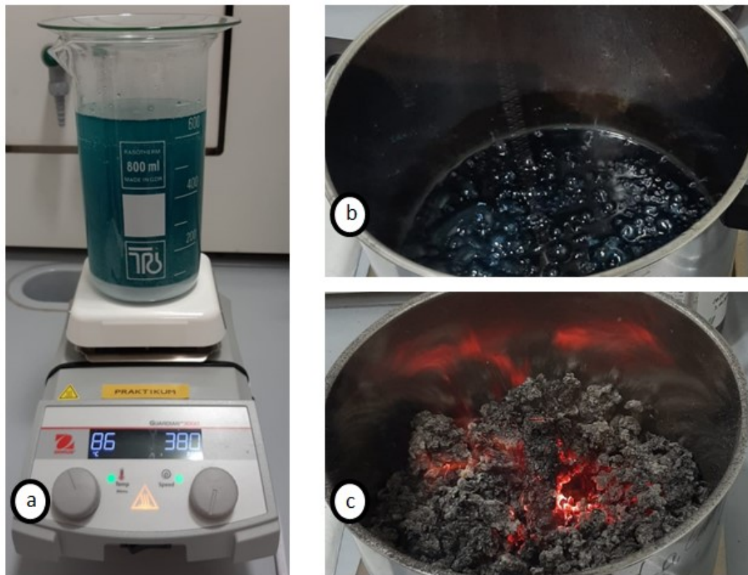
Abbildung 8: Synthese von LPNSGN mittels Sol-Gel-Verfahren.
