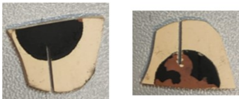
Abbildung 63: Zelle S042 nach der Probenvorbereitung für die REM-Analyse.
