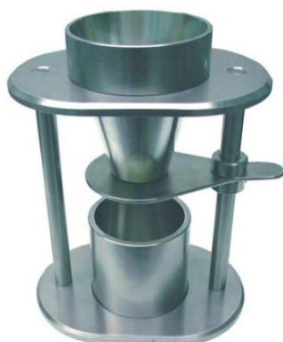
Abbildung 7-7: Schüttdichtemessgerät nach DIN ISO 697 [69]
