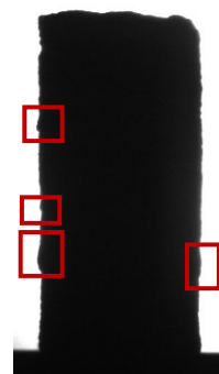
Oberfläche der Probe bei 1100 °C mit aufgeklappter Zunderschicht
