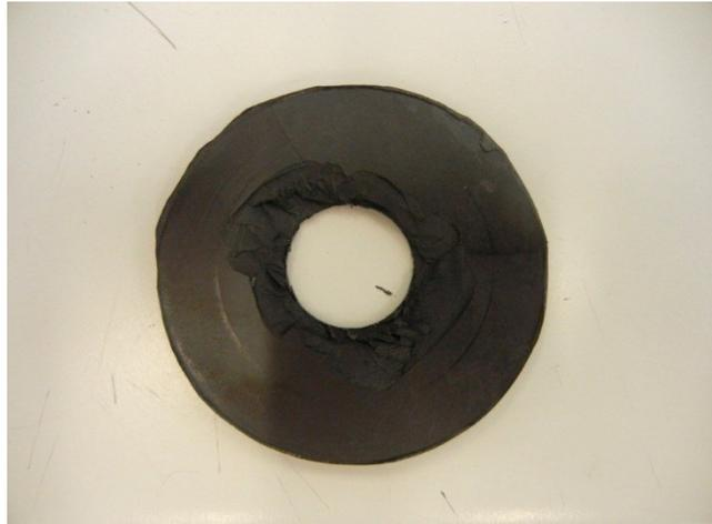
*Abbildung 31: PPS 320 CF35 nach dem Durchstoßversuch bei 23 °C*
