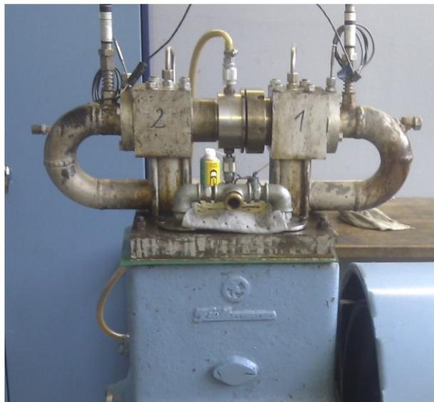
Abbildung 15: Vorrichtung für den zyklischen Plattentest
