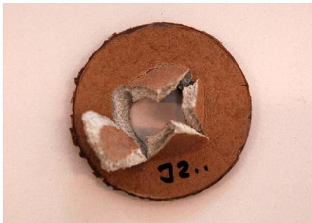
*Abbildung 32: TW441 µGF20 (PA) nach dem Durchstoßversuch bei 150 °C*
