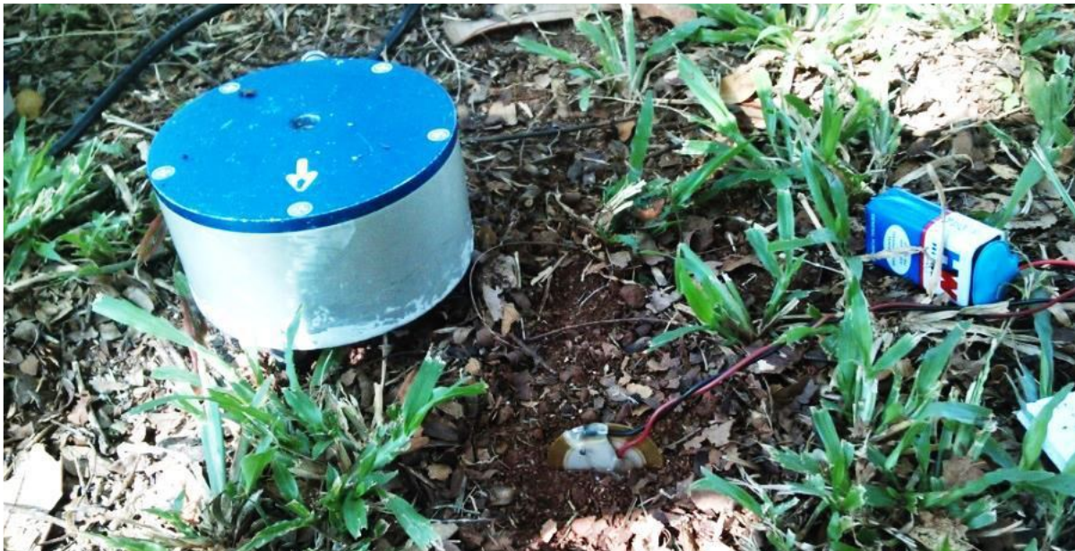
Abbildung 33: Im Boden platzierter Piezo-Aufnehmer [20]
