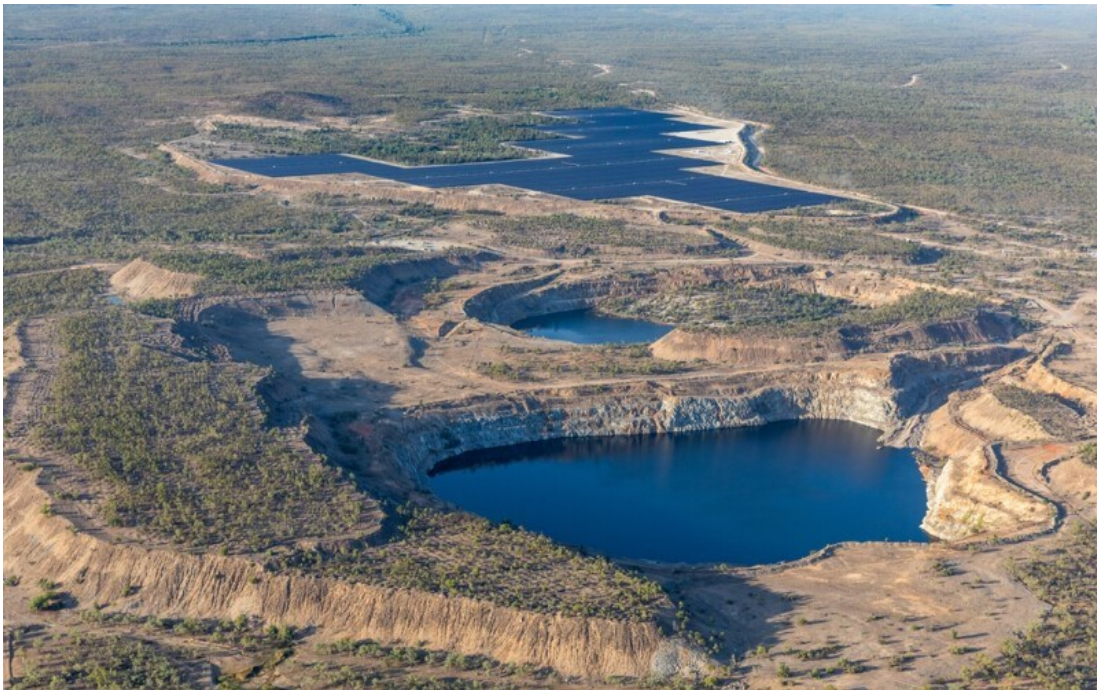
Abbildung 23: Übersicht von Ober- und Unterbecken mit Genex Solar Farm im Hintergrund [86]
