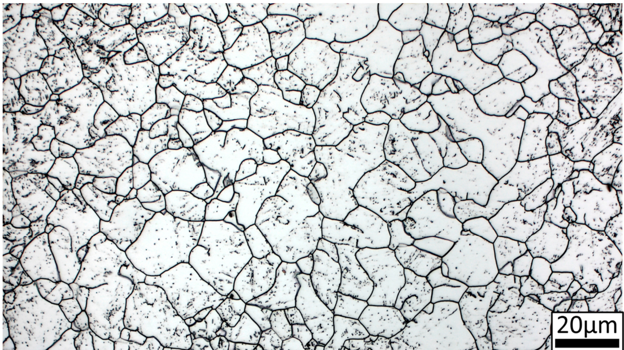
Abbildung A.2: Bild 2 der ehemaligen Austenitkorngrenzen im Zentrum der Probe OA – R.
