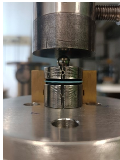
Abbildung 11: zusammengesetztes Doppelringauflager inkl. Probe
