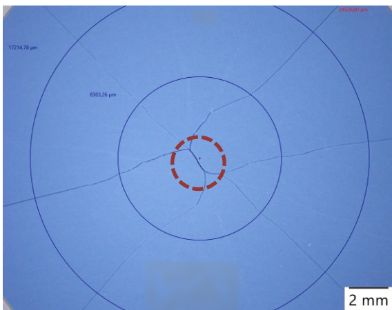
Abbildung 34: Bruchbild RoR Probe 34_02
