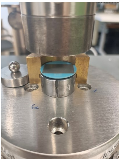
Abbildung 10: eine beklebte Probe auf den Auflagerring aufgelegt
