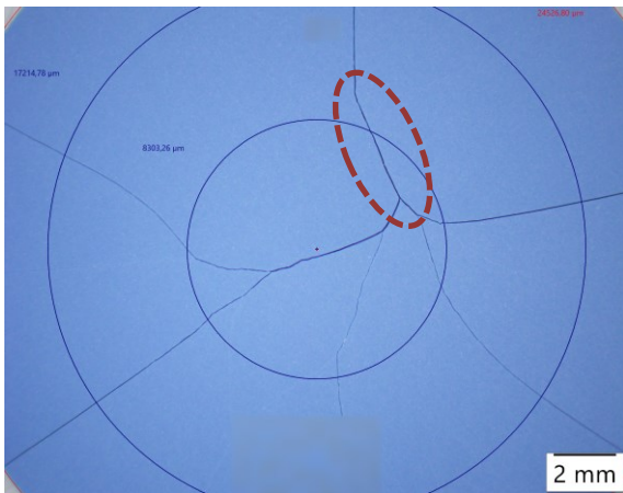
Abbildung 20: Bruchbild RoR Probe 30_01
