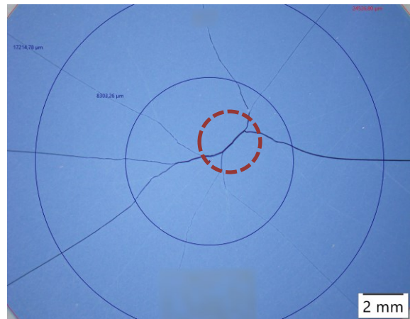
Abbildung 39: Bruchbild RoR Probe 35_07
