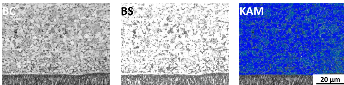
Abb. 135: Unverformter Bereich an der Oberfläche einer Biegeprobe des DP980. Normalschliff TDxND. Stepsize 120 nm
