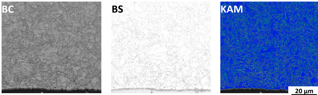
Abb. 127: Unverformter Bereich einer Biegeprobe des CP980. Stepsize 120 nm
