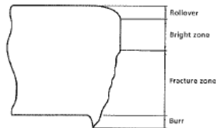
Abbildung 2-20: Einteilung der Schnittflächenzonen in Einzugsbereich (Rollover), Glattschnittzone (Bright zone), Bruchzone (Fracture zone) und Grat (Burr) [114].
