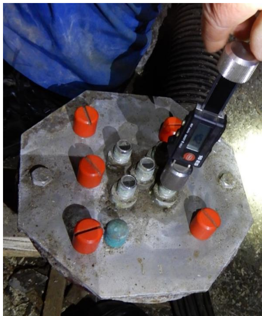
Abbildung 52: Messung am Extensometer-Kopf
