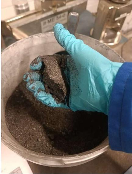
Abbildung A- 12: „ball in hand“ Test der Mischung mit B<sub>2</sub>O<sub>3</sub> als Additiv
