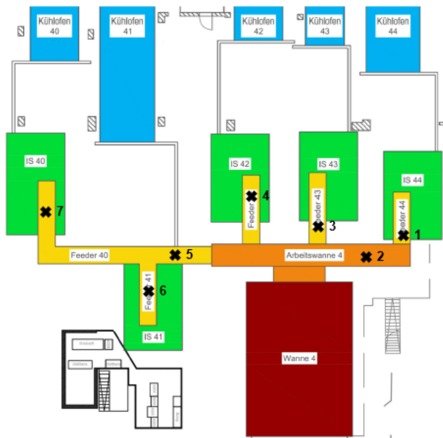
Abbildung 3-15: Absaugpyrometermesspunkte an der Braunglasproduktion
