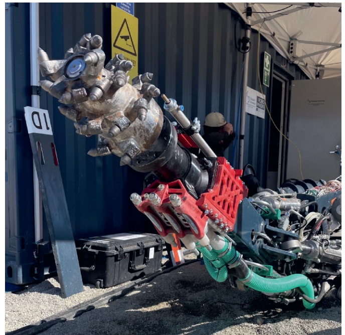
Fig. 11. Fully assembled ore collection system comprising nozzle (red), Venturi (clear) and mounting brackets (red) as well as all in- and output hoses. // Bild 11. Zusammengebautes Fördersystem (rot) Venturi (transparent) und Halterung (rot) sowie Zu- und Abflussleitungen. Photo/Foto: Source/Quelle: MU Leoben
