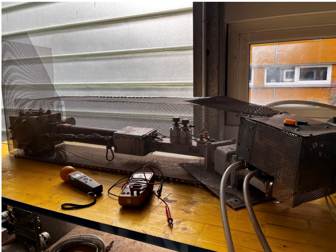
Abbildung 13: Mikrowellensetup zur grundlegenden Überprüfung der Funktionstüchtigkeit des Mikrowellengenerators (von links nach rechts: Hohlleiter, Zweistifttuner, Isolator, Magnetron)
