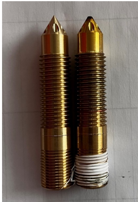
Abbildung 43: Vergleich Koaxialresonator nach der Fertigung (links) und nach dem missglückten Zündversuch (rechts)
