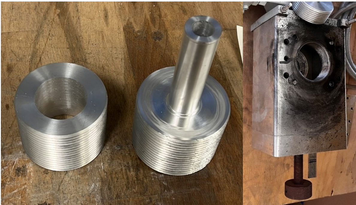
Abbildung 15: Aluminiumgehäuse TIA-Brennkammer (in Abbildung 14 orange dargestellt), Gehäuseschrauben (links und mittig), Gehäuse (rechts)
