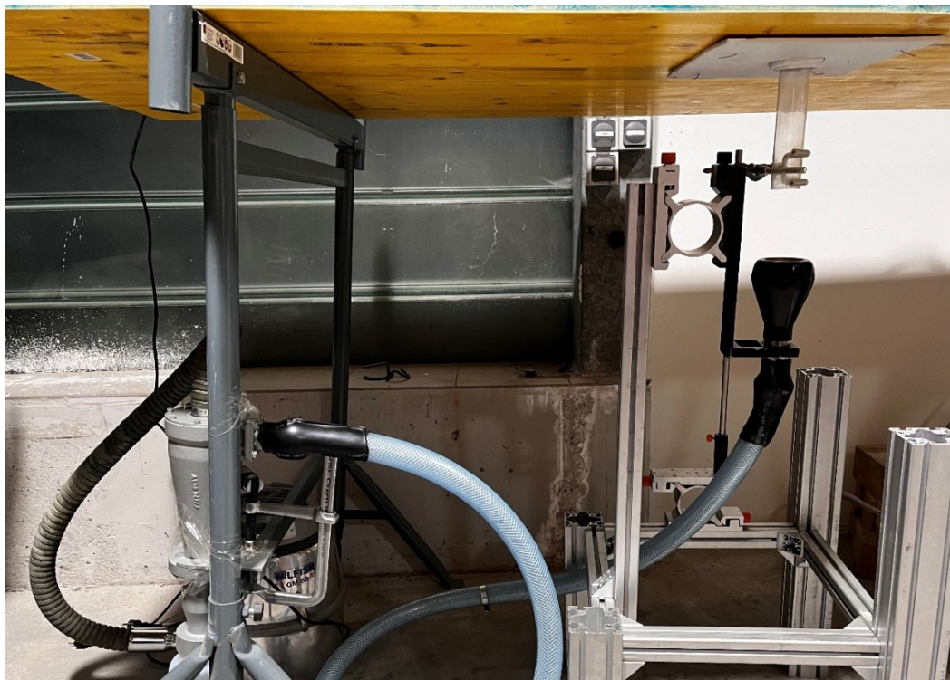
Abbildung 26: Auffangvorrichtung für das Produkt, Zyclon mittels Staubsauger betrieben
