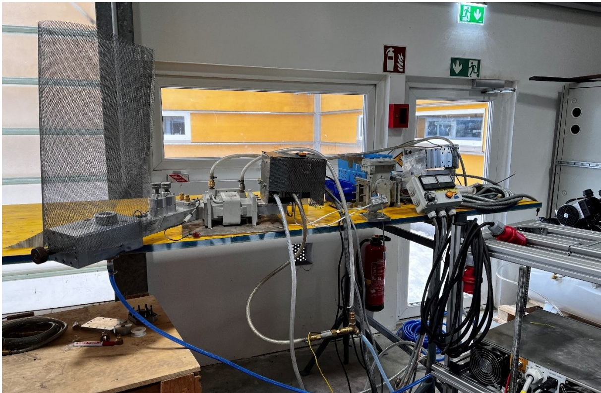
Abbildung 19: Fertiges TIA-Setup: Koppellement mit Brennkammer, Zweistifttuner, Isolator, Magentron (von links nach rechts)
