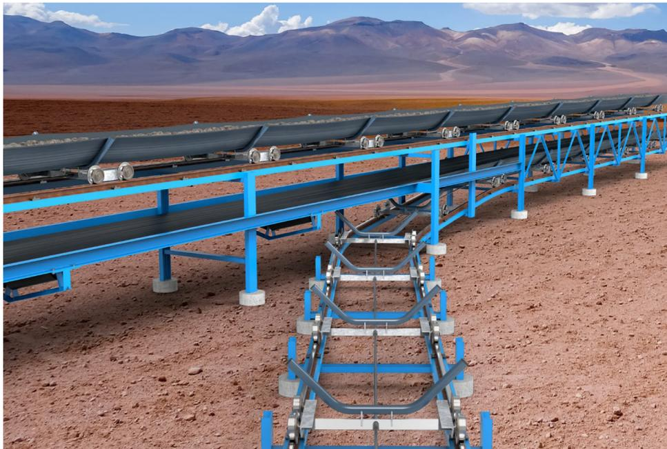
Abbildung 4.8: Rail-Running Conveyor als offener Gurt [4]
