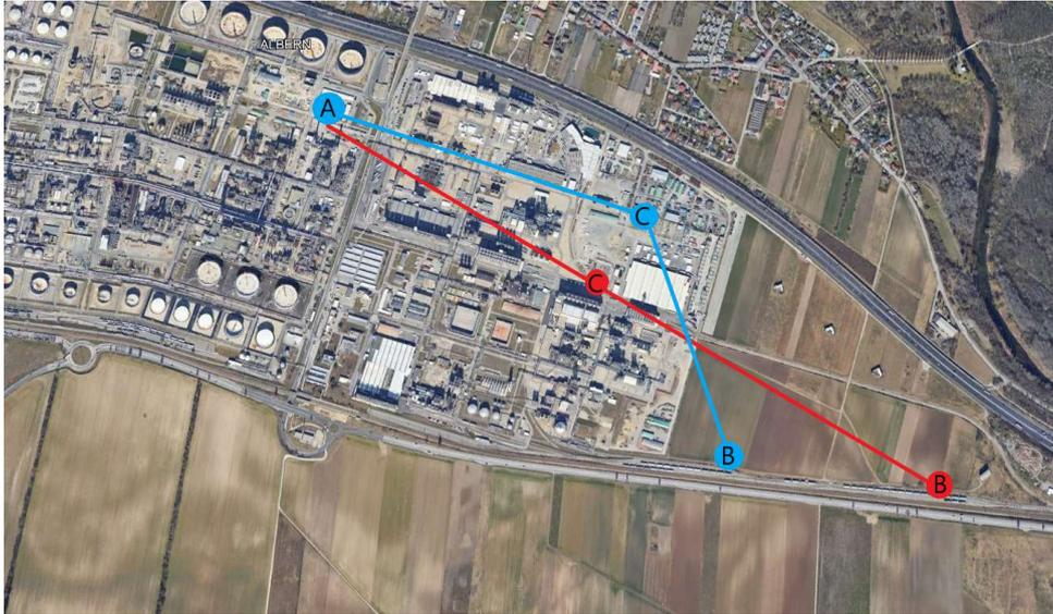
Abbildung 5.5: Förderstrecke 1 konventionelle Seilbahn (rot) und Standseilbahn (blau) [21]
