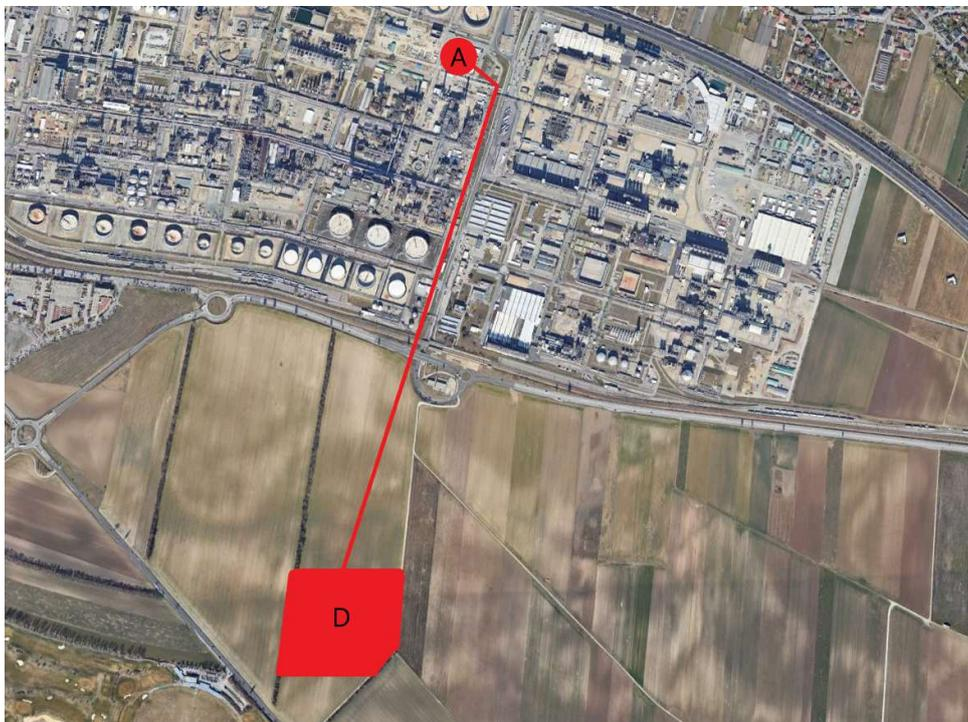
Abbildung 5.10: Förderstrecke 2 - Streckenführung Schlauchgurtförderer Beumer [21]
