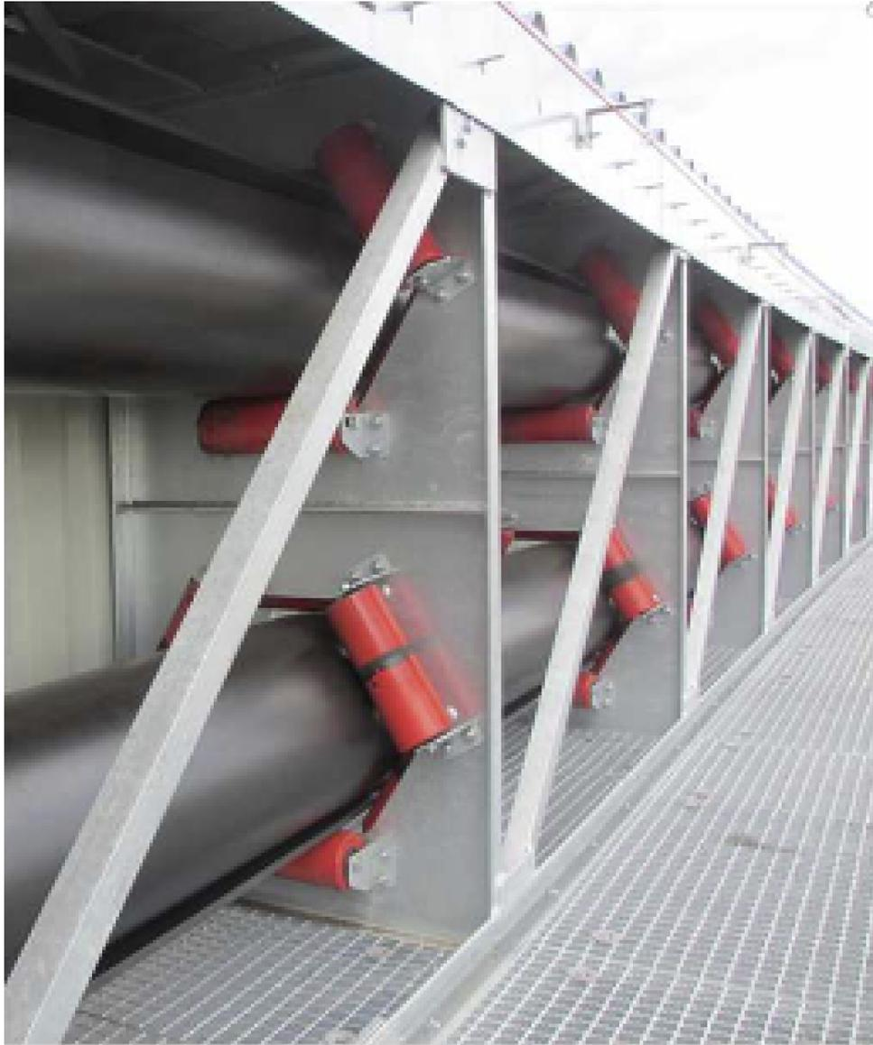
Abbildung 4.6: Schlauchgurtförderer Ober- und Untertrum [25]
