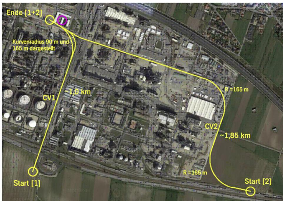
Abbildung 5.4: Streckenverlauf Rail- Running- Conveyor [4]
