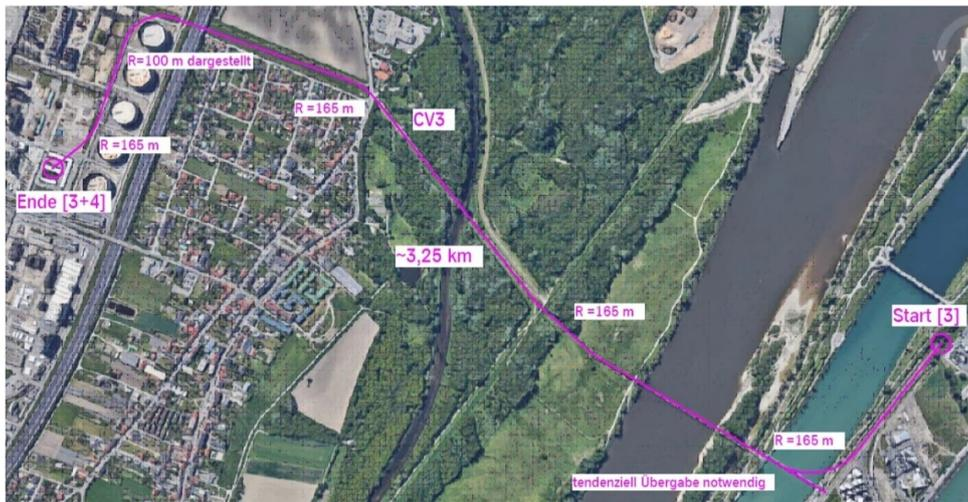
Abbildung 5.15: Routenführung Rail-Running-Conveyor Thyssenkrupp F3 [4]
